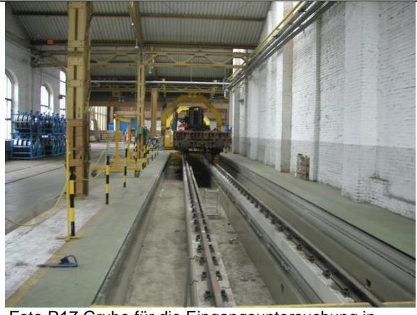
Foto R17 Grube für die Eingangsuntersuchung in Gleis 5
