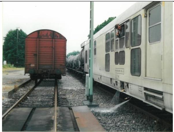
Abb. 23 Prüfung der Spritzdüsen, links die gesicherte Fläche der Diesellokstation (Gleis 30), Februar 1995
