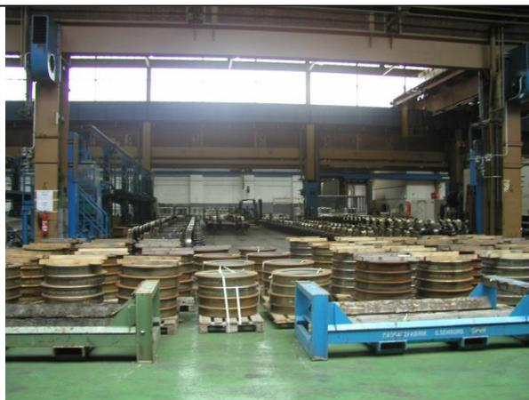
Foto B59 Das Schiebebühnenfeld wird auch zur Lagerung von Radscheiben genutzt.
