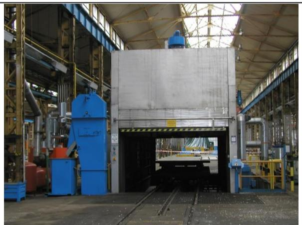
Foto B7 Waschanlage für Drehgestelle in Hallenschiff 7
