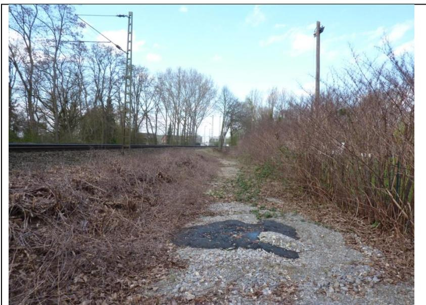
Abb. 9 austretendes Säureharz aus der Abdeckung, 06.04.2016
