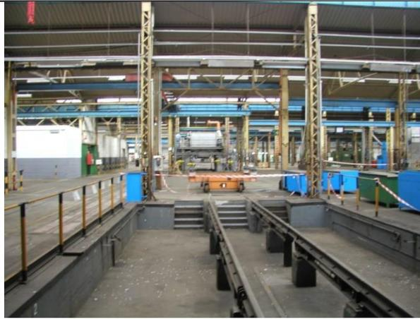
Foto B1 Gleis 5 Drehgestelldemontagegrube in Hallenschiff 9
