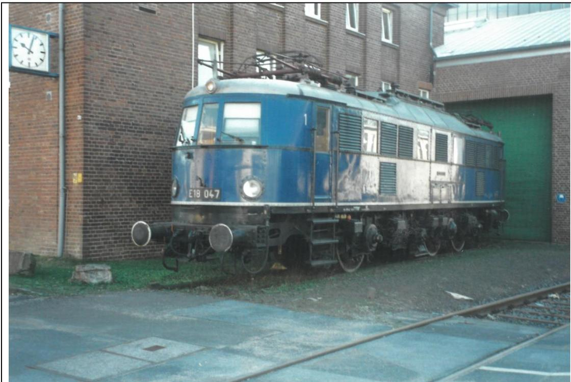
Abb. 430 E18 047 ohne Laufachsen und mit einer fehlender Antriebsachse im AW Opladen, Gleis 3 vor dem Würfelbau, 15.02.02
