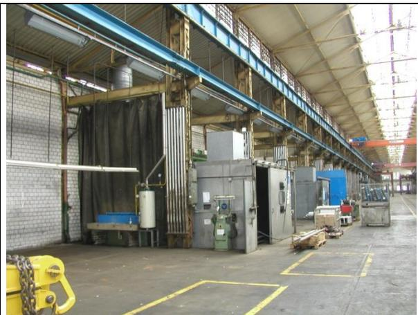
Foto B14 Ausblaskabinen für Kollektoren in der Fahrmotoren (Fm)-Abteilung in Hallenschiff 3
