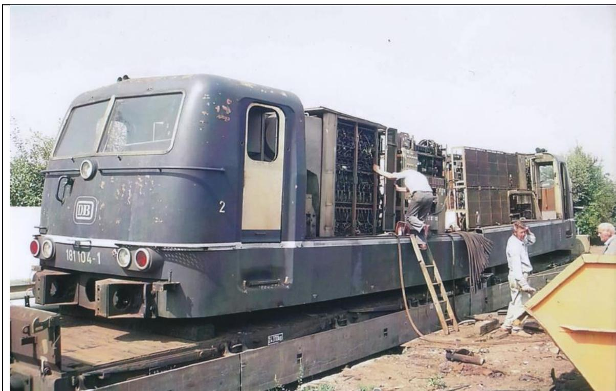
Abb. 438 181 104 wurde zur Zerlegung ohne Drehgestelle auf einem Flachwagen angeliefert. Rechts August Bender, 19.08.93
