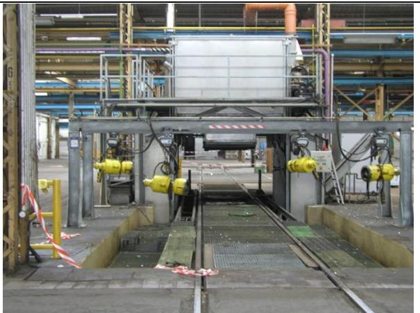
Foto B5 Schrauber (gelb) zur Trennung von Radscheiben und Achsen, dahinter die Waschanlage für Achsen, Gleis 5
