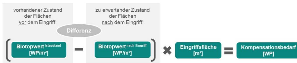
Abb. 6: Differenzmethodischer Ansatz zur Ermittlung des Kompensationsbedarfs nach § 7 Abs. 1 BKompV
