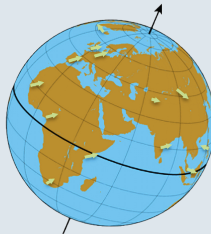
△ Abb. 2b: Realisierung eines erdfesten Referenzsystems z. B. als WGS 84 (Gwww) oder ITRFyyyy mit Stationen an der Erdoberfläche und deren Koordinaten und Geschwindigkeitsvektoren. (Quelle: ZGeoBw/Görres)
