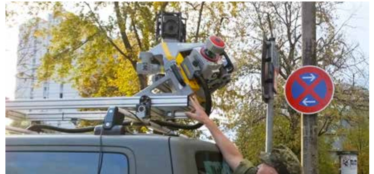
Multisensorsystem MX-9 auf dem VW Widder montiert; Quelle: ZGeoBw/ Almasi
