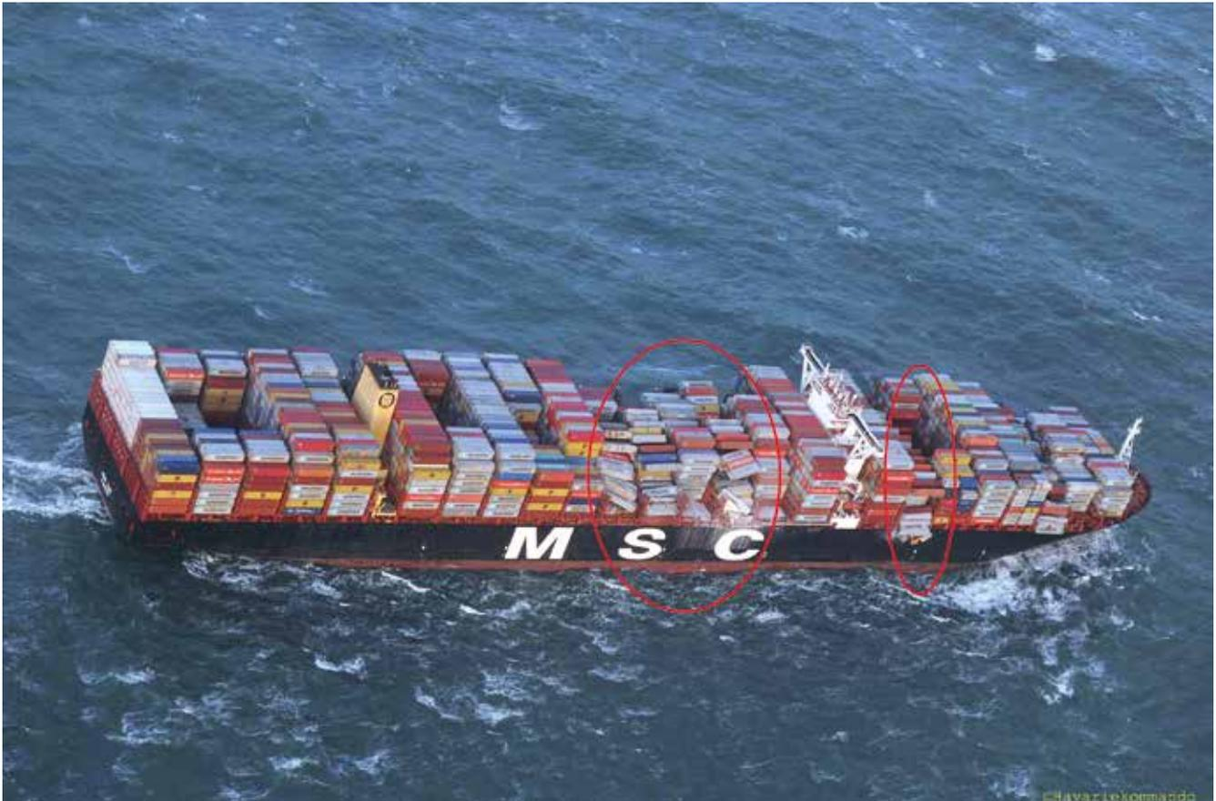
**Abb. 8a:** Großcontainerschiff MSC ZOE (395 m Länge). Verschiedene Containerstacks kollabierten, 342 Container fielen außerbords. (Quelle: Havariekommando)
