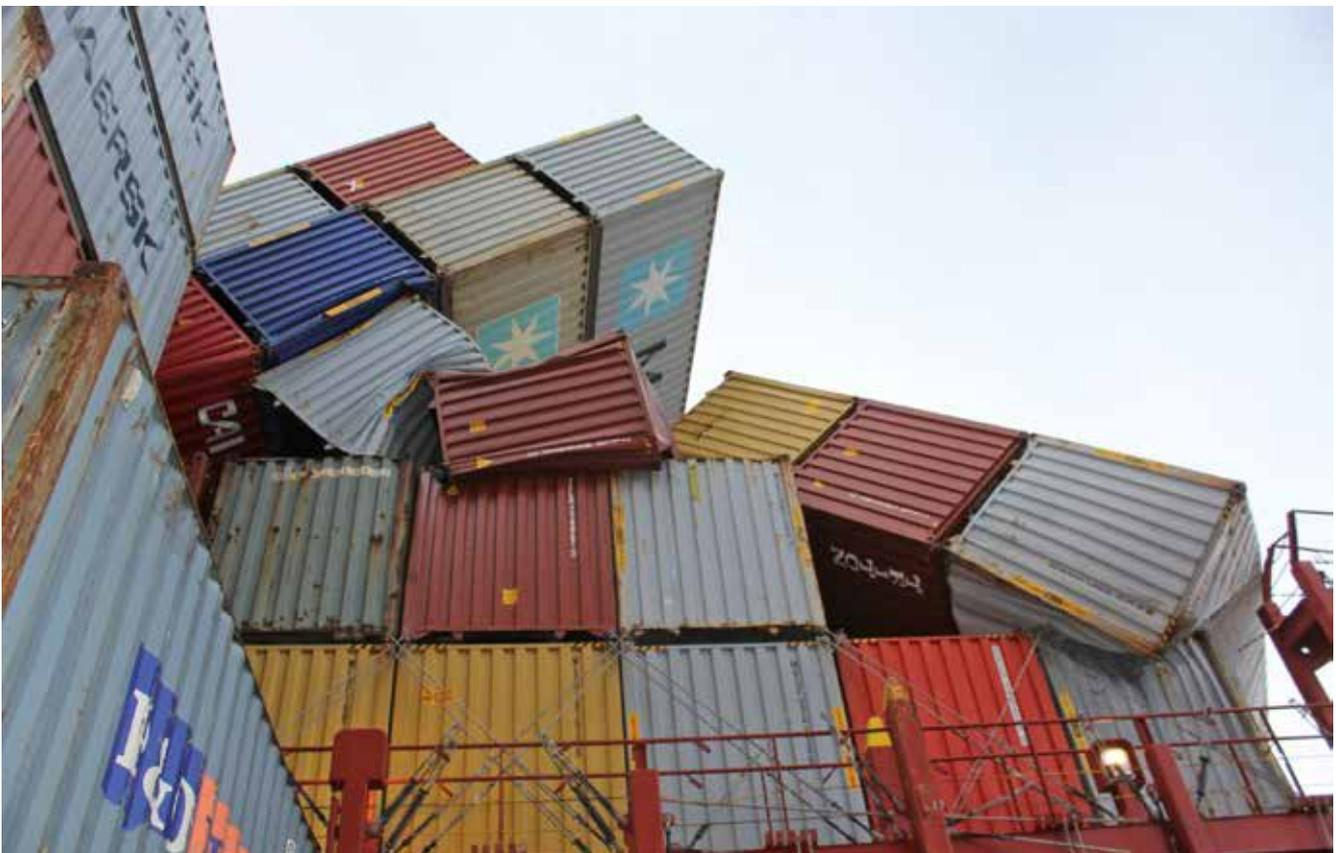
**Abb. 8b:** Einzelne deformierte Container. (Quelle: Havariekommando)
