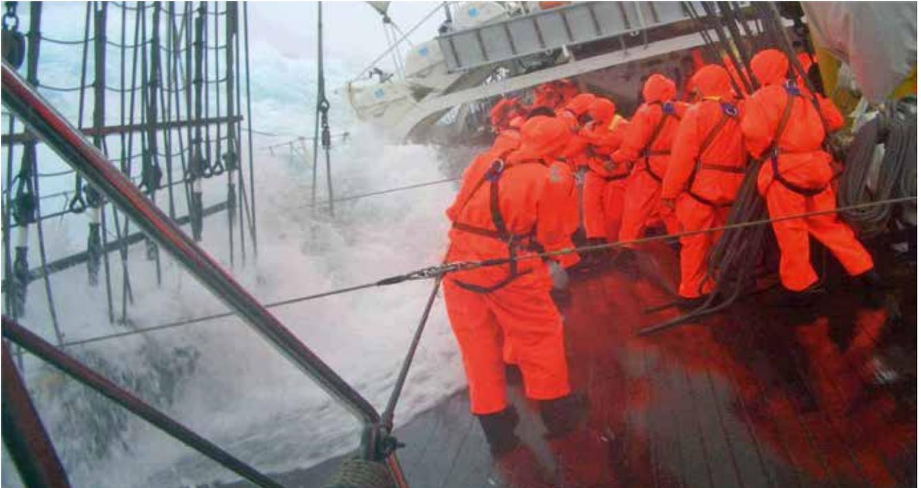
**Abb. 9:** Segelschulschiff GORCH FOCK in schwerer See. Das Deck ist abgespannt, die Besatzung ist mit Lifebelt und Life-line sicher eingehakt. (Quelle: Marineamt, Abteilung Geoinformationswesen)
