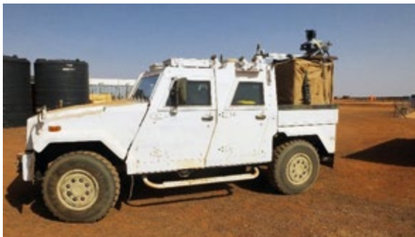
△ Abb. 1: Multisensor MX-9 adaptiert auf EAGLE IV in GAO MALI. (Quelle: ZGeoBw)
