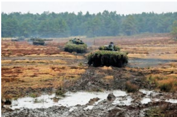
△ Abb. 2: Geländebefahrbarkeit Puma und Leopard II in der Lüneburger Heide. Die GeoInfo-Beratenden können hier eine grundsätzliche Bewertung abgeben, Einzelphänomene wie die im Vordergrund erkennbare Wasserfläche können nur durch direkte Aufklärung identifiziert werden. (Quelle: Bundeswehr/Wilke)
