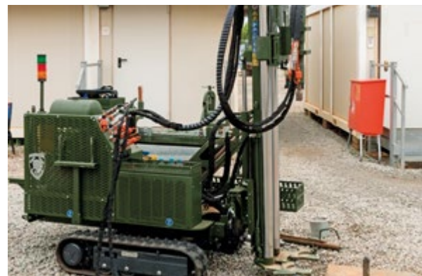
△ Abb. 6 : Sondierdraupe für ingenieurgeologische Erkundungen. (Quelle: ZGeoBw)
