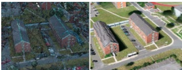
△ Abb. 12: Infrastrukturerfassung: links 3D-Laserpunktwolke, rechts texturiertes 3D-Modell. (Quelle: ZGeoBw)
