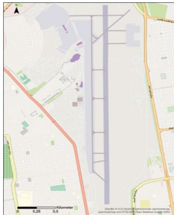
△ Abb. 1: Exemplarische Darstellung des Flughafens Khartoums über verschiedene Zoomstufen in der BaseMap. Die Generalisierung der Daten erfolgt über den Stil und nicht über die Daten, weshalb man von einer Pseudo-Generalisierung spricht. (Quelle: ZGeoBw)
