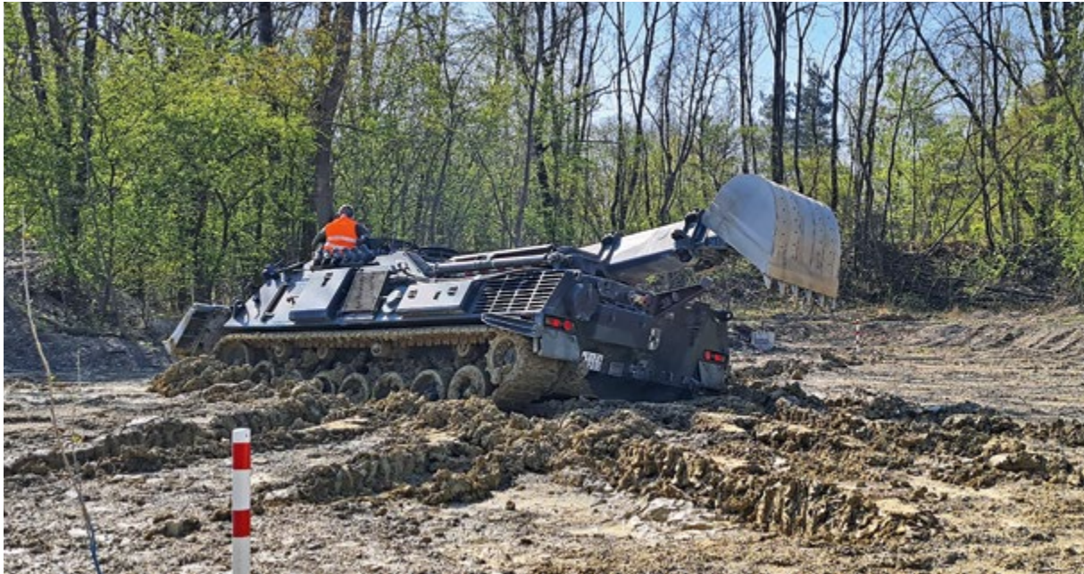
△ Abb. 2: Befahren und Bearbeiten von Uferzonen mit Pionierpanzer DACHS. (Quelle: Pionierschule)
