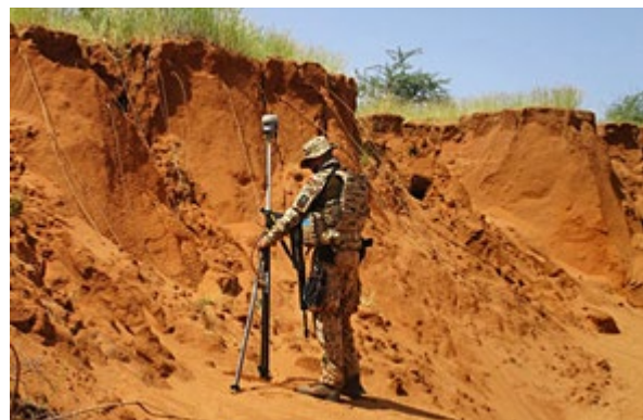
△ Abb. 2: Einsatzvermesser beim Aufmaß einer Böschung zur Erstellung eines DGMs. (Quelle: ZGeoBw)
