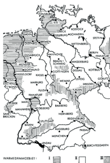
Abb. 5: Wärmedämmgebiete I, II und III gemäß DIN 4108:1952-07
