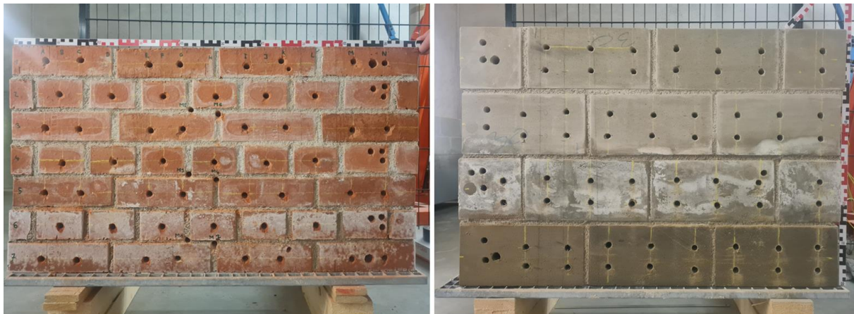
Abbildung 38: Erstes Mauerwerkspaar nach der Bohrmehlentnahme. Aufgrund der unterschiedlichen Mauerkonstruktionen wurde für jedes Material ein eigenes orthogonales Raster angelegt.
