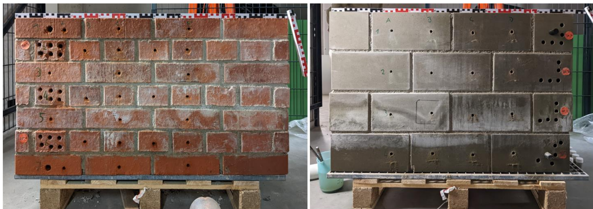
Abbildung 41: Zweites Mauerwerkspaar mit deutlich reduzierter Probenmenge. Bei der zweiten flächenhaften Messaktion wurde die entnommene Probenmenge reduziert. Hier gut am rechten oberen Eck des Sandsteinprobekörpers (rechts) zu sehen ist die teilweise Zugabe an Wasser von oben. Das linke und deutlich hellere Eck scheint augenscheinlich noch weitestgehend trocken zu sein. Äquivalent dazu, in der Aufnahme allerdings nicht zu erkennen, wurde die linke obere Hälfte der Ziegelmauer zusätzlich bewässert.
