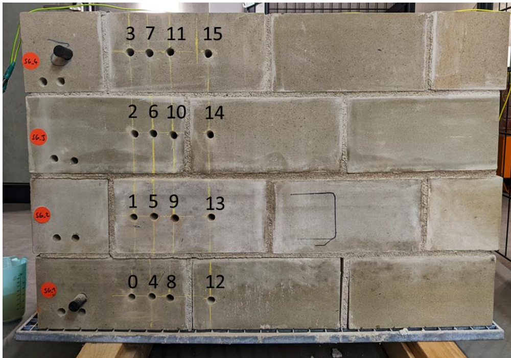
Abbildung 68: Sandsteinmauer mit den insgesamt 16 Messpositionen aus vier Probenahmeaktionen, die den Trocknungsverlauf über etwa drei Wochen darstellen sollen.
