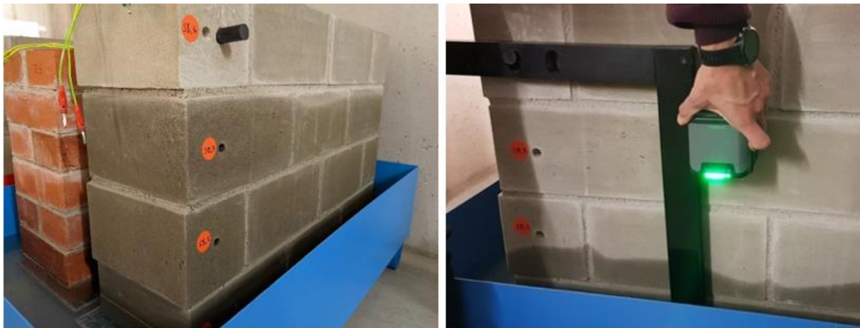
Abbildung 35: Links: Mauerwerke kurz vor dem Ablassen des Wassers. Rechts: Messung mit dem Radargerät entlang der Positionierungshilfe aus AP4. Im linken Bild ist gut der Saughorizont am Sandsteinmauerwerk kurz nach dem Ablassen des Wassers zu sehen.
