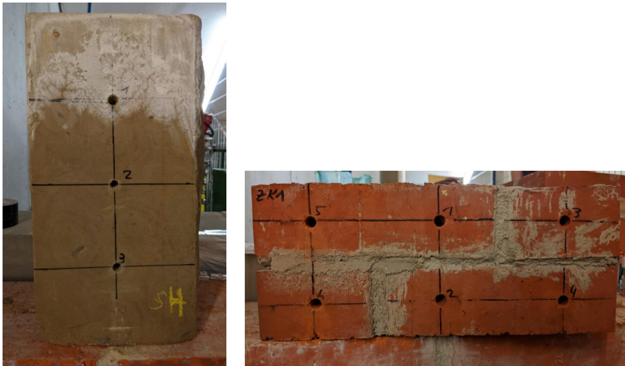
Abbildung 43. Links: Sandsteinblock nach der 3. Bohrmehlentnahme. Sandsteinblock der insgesamt schon 3-mal vermessen wurde. Im oberen Drittel sind schon deutliche Salzausblühungen zu sehen. Rechts: kleiner Ziegelprüfkörper mit insgesamt 6 Bohrlöchern.
