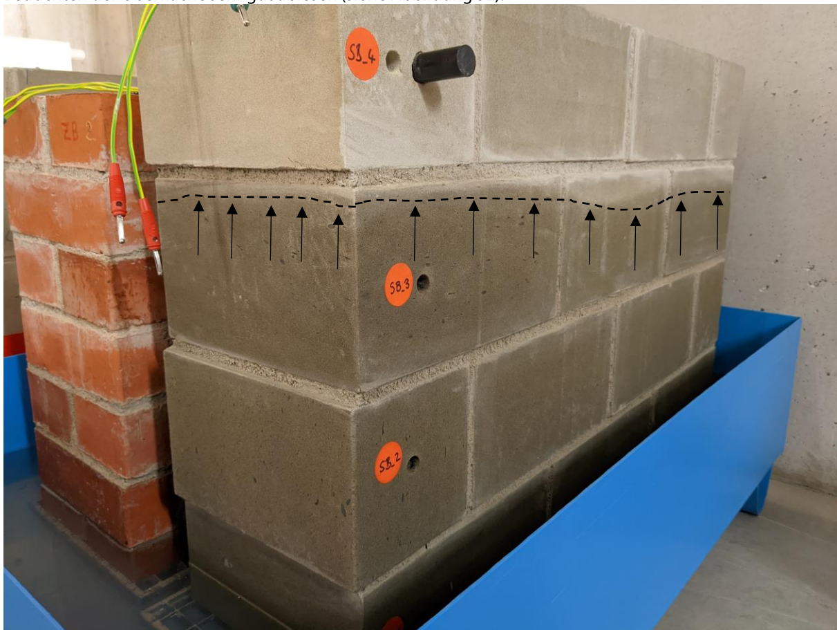
Abbildung 32: Steighöhe des Wassers, gut erkennbar am Sandsteinmauerwerk.
