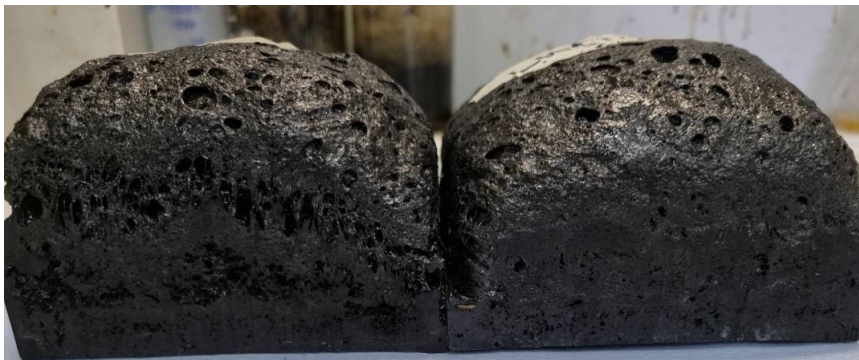
Abbildung 5 Lignin-Furan-Schäume unterschiedlicher Dichte
