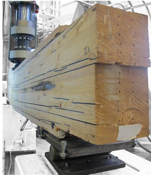
Abbildung A- 28: Rissbild am Querschnittsende gegenüber des Prüfbereichs (beispielhaft R-IV)
