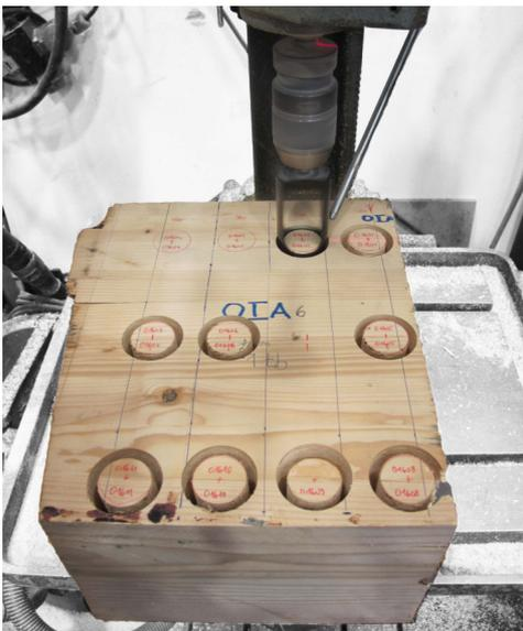
Abbildung A- 55: Ausbohren der Bohrkerne auf einer Ständerbohrmaschine
