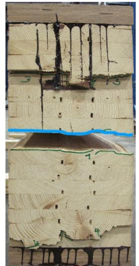
Abbildung A-8: Belastungs- und Verformungshistorie beim Biege-Schubversuch K-VIII;
