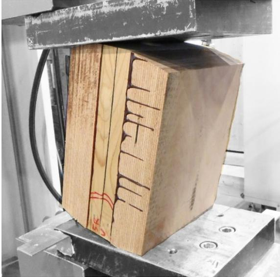
Abbildung A- 36: Schubprüfung der vollen Querschnittsbreite
