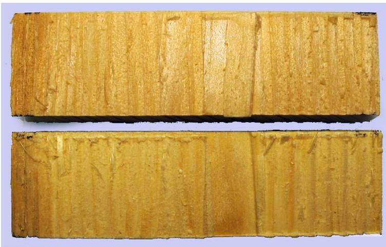
Abbildung A- 61: Scherflächen des Scherprüfkörpers O2622; links: Vorab-Delaminierung
