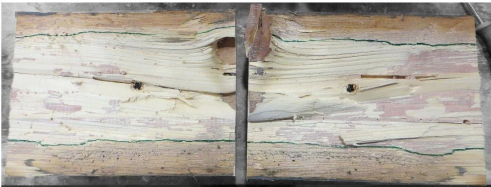
Abbildung A- 38: Klebefugenebene nach Prüfung; erkennbar sind die vorab delaminierten Fugenrandbereiche
