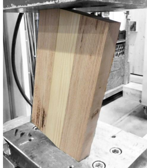
Abbildung A- 37: Schubprüfung mit Normbreite = 32 mm
