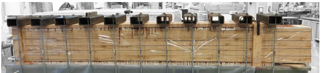
Abbildung A- 16: Verklebung der Biege-Schubversuchskörper
