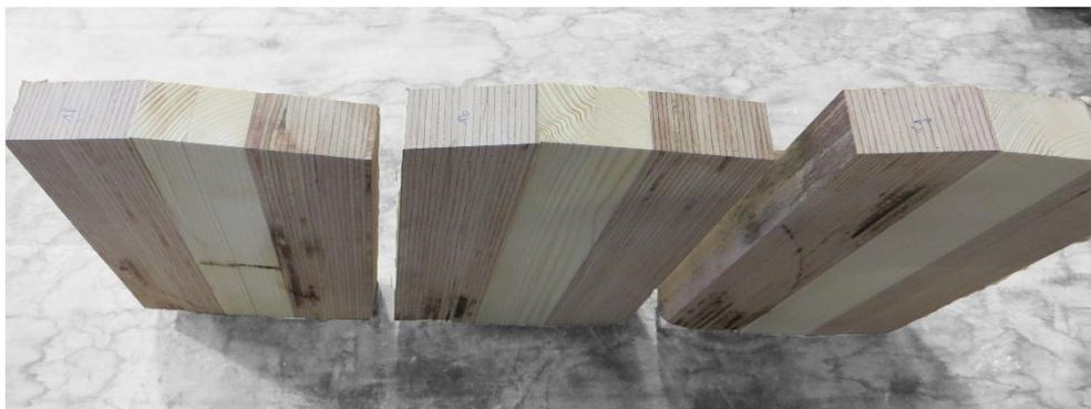
Abbildung A- 35: aufgetrennter Versuchskörper, Breite = 32 mm
