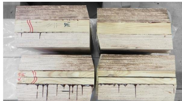
Abbildung A- 34: Herstellung der Versuchskörper durch aufgeklebte Lasteinleitungsplatten
