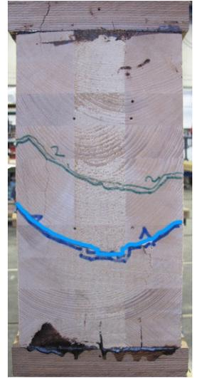
Abbildung A-19: Belastungs- und Verformungshistorie beim Biege-Schubversuch R-IX; Bruchbild am Querschnittsende des Prüffeldes
