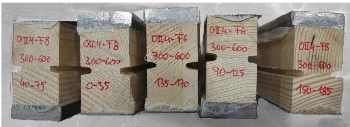
Abbildung A- 45: Schubprüfkörper mit verjüngter Breite durch Fräsen eine Nut
