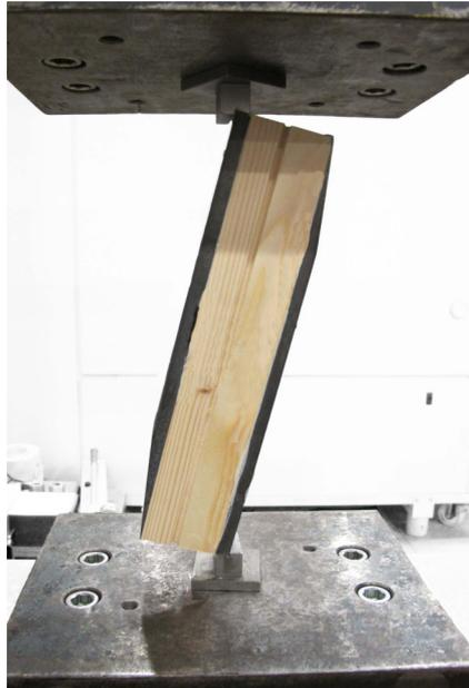
Abbildung A- 46: Versuchsaufbau Schubversuche nach EN 408
