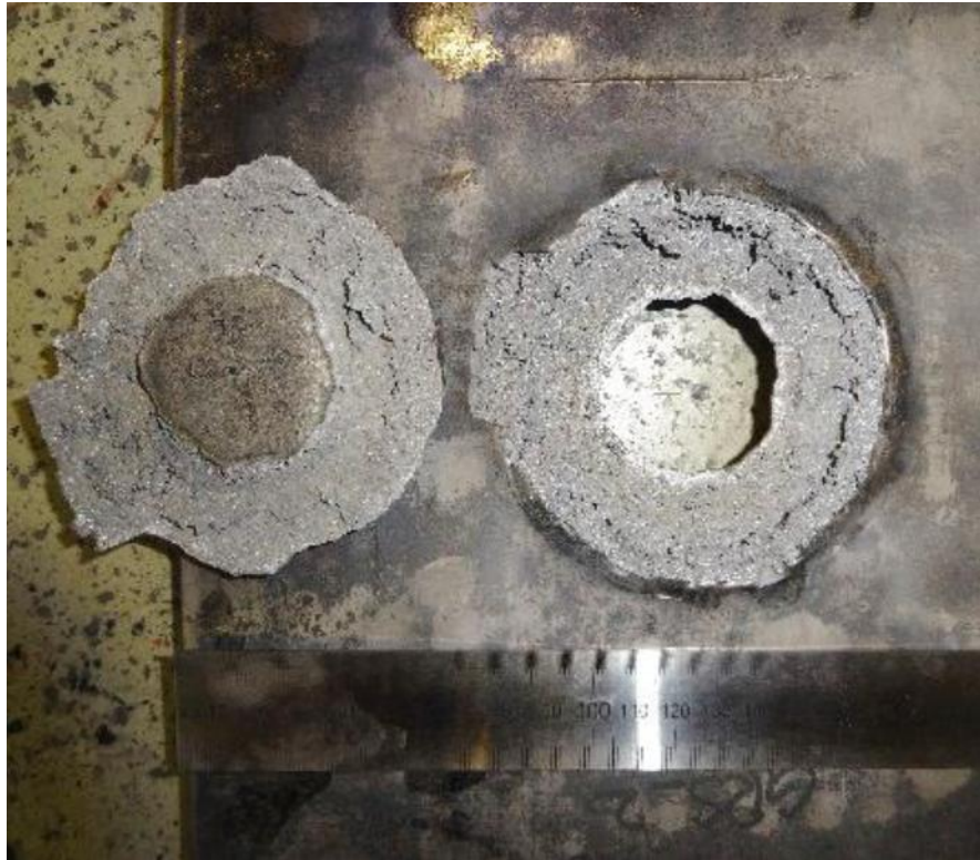
Abb. 2.1 Schadensbild der Stahlplatte aus Forschungsvorhaben 3613R01605 /GRS 16b/ nach der Sprengung mit danebenliegendem Abplatzer
