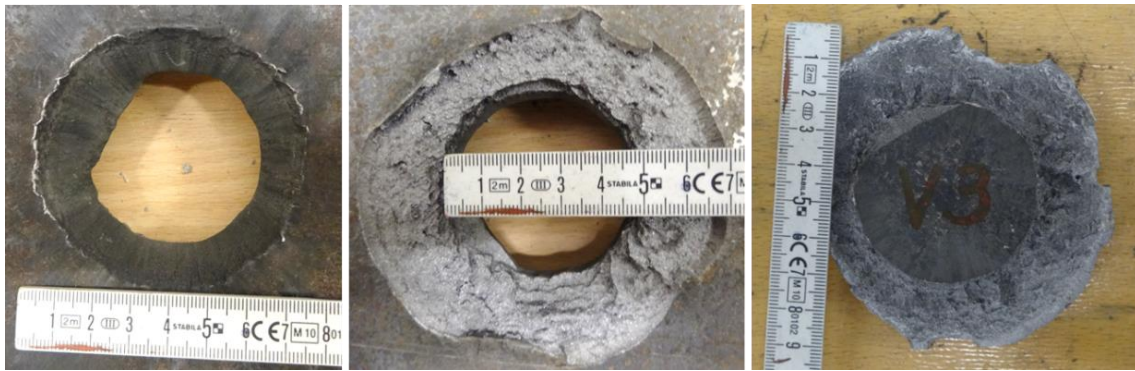
Abb. 5.26 Versagensbild der Metallplatte von Versuch 8 aus /GRS 16b/
