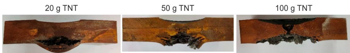
Abb. 2.9 Schadensbilder der Stahlplattenquerschnitte in Versuchen aus /HEY 23/
