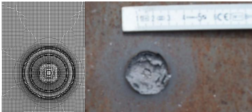
Abb. 7.16 Verformungen der Rückseite in Vorversuch FX760 in Simulation (links) und Schadensbild im Versuch (rechts)
