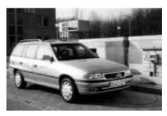
tauglichkeit. Die Fahrzeuge unterschieden sich äußerlich - abgesehen von der fehlenvon der gängigen Version mit Verbrennungsmotor. Die Elektro-Autos fahren bis zu 110 km/h schnell und aut 130 "Tankfüllung"; getankt wird an der Steckdose. Bei sparsamer Fahrweise sogar bis zu 202 Kilometern. Für Stadtfahrten reicht das Leistungsvermögen der Fahrzeuge damit völlig aus.
