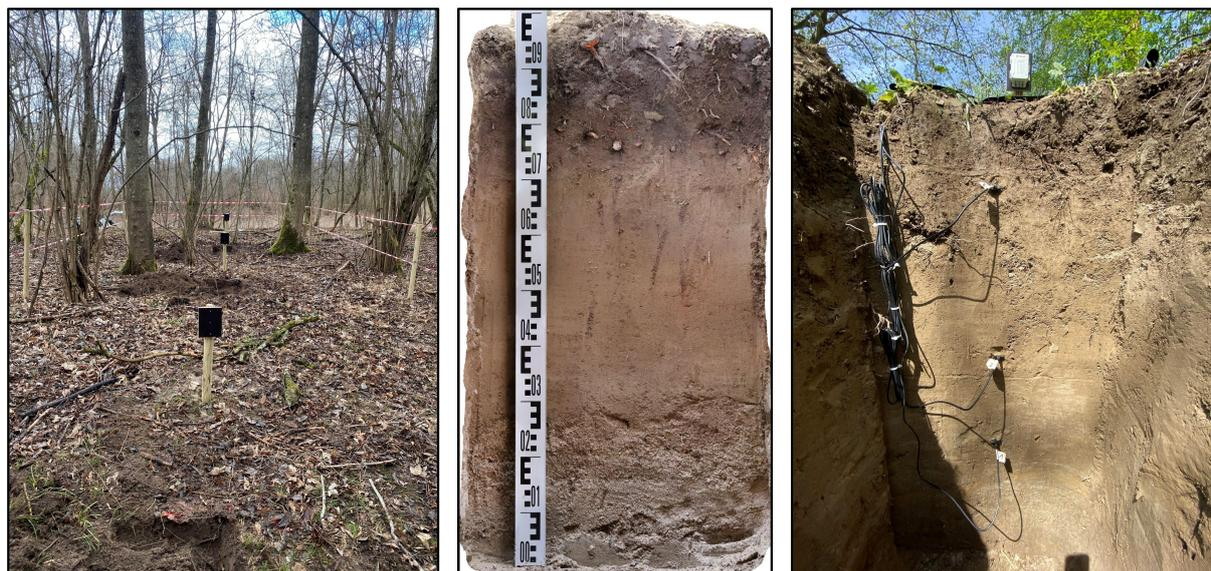
Abb. 22: Links: Bodenfeuchtetranssekt; Mitte: Orthophoto eines Bodenprofils mit Maßstab, rechts: vertikale Anordnung der Bodenfeuchtesensoren im Bodenprofil mit Datenlogger (oben) (Fotos: Tim Borgs).
