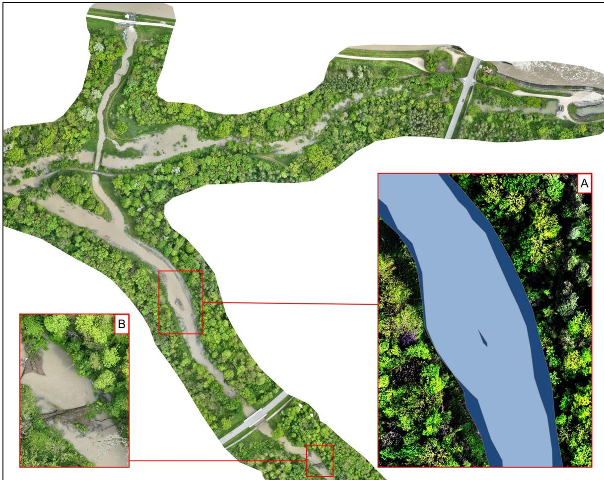
Abb. 20: Orthofoto des OHB und des Längenmühlbachs während der ökologischen Flutung im Mai 2023. A: Kartierte Überflutungsfläche (dunkelblau) der Stufe 2 (Klassifizierung aus MONDAU I) und Überflutungsfläche einer Stufe 2 Flutung (hellblau) im Jahr 2023. B: Verkläuerung unterhalb der Staatsstraße 2043 (Quelle: Tim Borgs).
