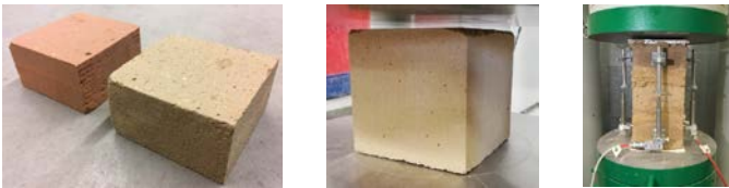
Abb. 2: Probekörper der untersuchten Lehmsteine (links), des Lehmmauermörtels (Mitte) und des Lehmmauerwerks (rechts). Quelle: Maximilian Brinkmann
