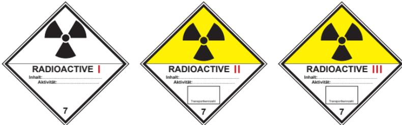
**Abb. 12-1** Kennzeichnung von Versandstücken und Transportfahrzeugen mit radioaktiven Stoffen. (Aus GGVS vom 17. Juni 2009; BGBl. I, S. 1389.)
