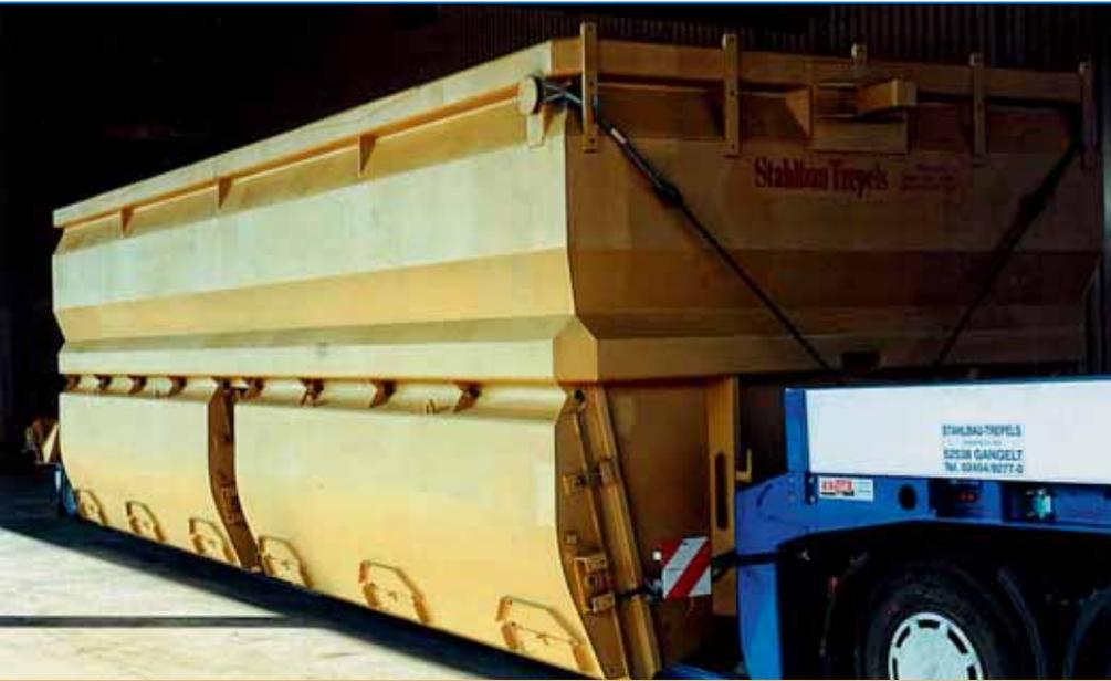
Mit dem firmeneigenen Tieflader wurden die rund zehn Meter langen, 4,10 Meter breiten und 3,5 Meter hohen Waggonaufbauten zum Kunden gebracht.
