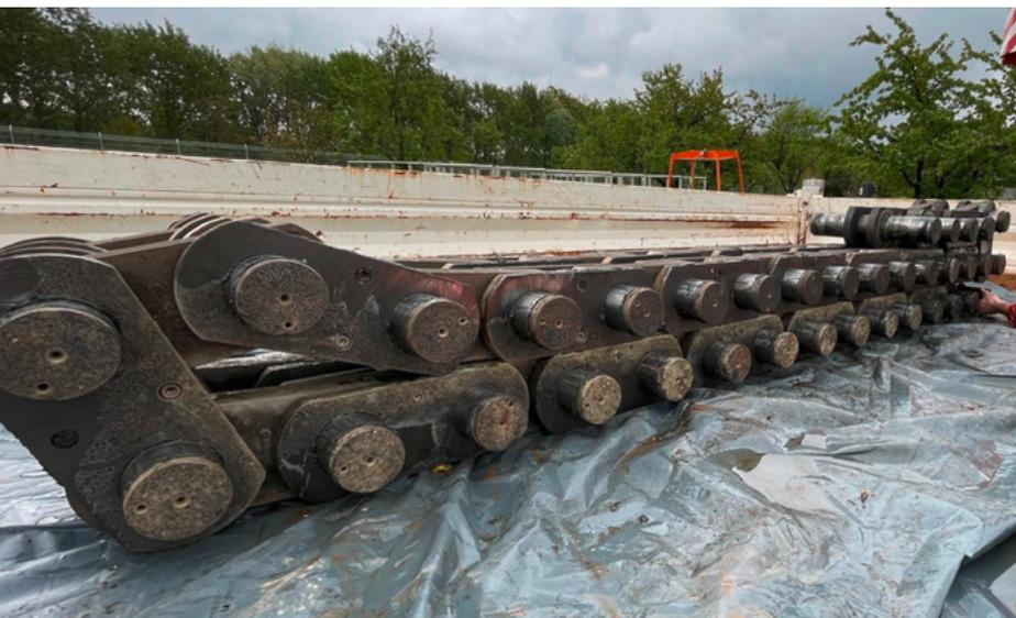
Inspektion an der ausgebauten Kette
