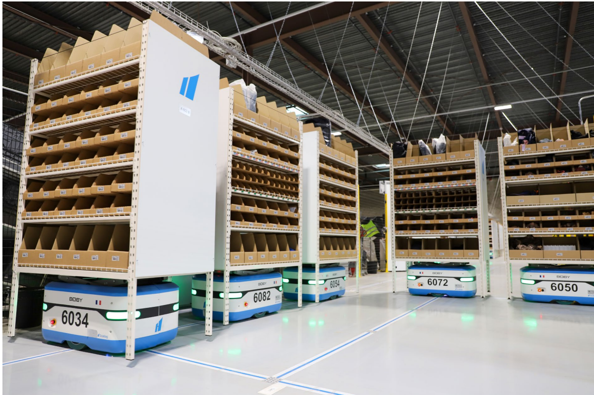
Abbildung 3: Ein Beispiel für ein verteiltes Robotersystem von Scallog, das in Lagereinrichtungen eingesetzt wird
