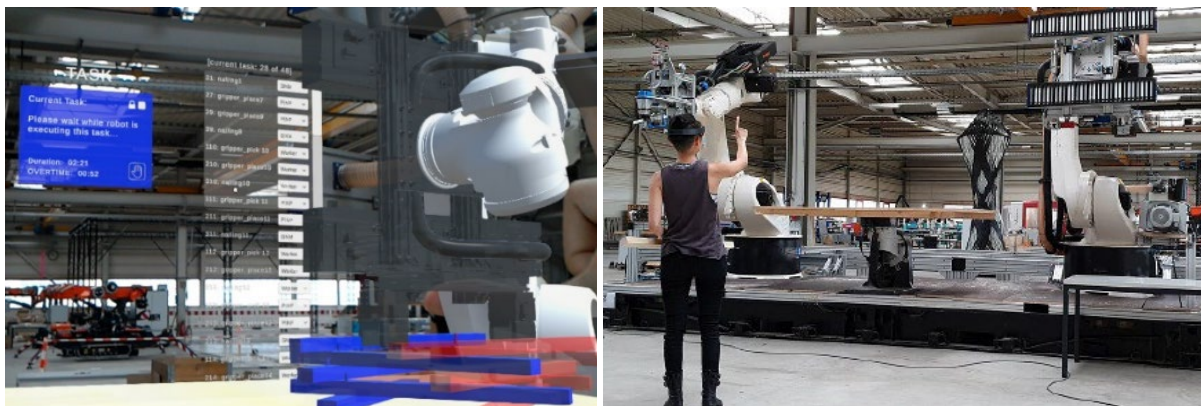
Abbildung 48: AR-Integration bei der Konstruktion von Holzkonstruktionen. AR-Visualisierung auf der HoloLens 15 (links) und ein Handwerker, der die HoloLens trägt, um mit einem Industrieroboterarm zusammenzuarbeiten (rechts).
