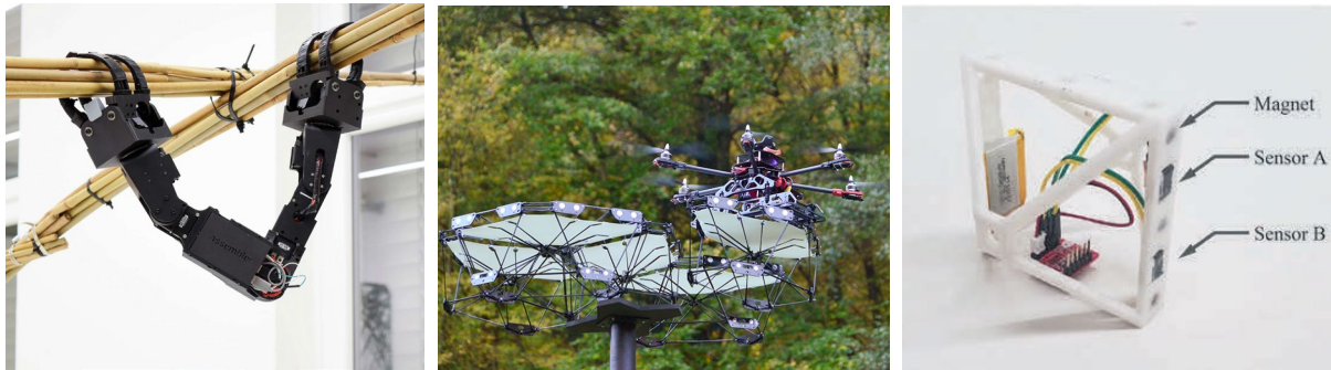
Abbildung 14: Mobiler Roboter für den Bambusbau (links), Drohne für die Montage von Cyber Physical Macro Material (Mitte) und Custom Material für die Montage durch einen individuellen Roboter (rechts)
