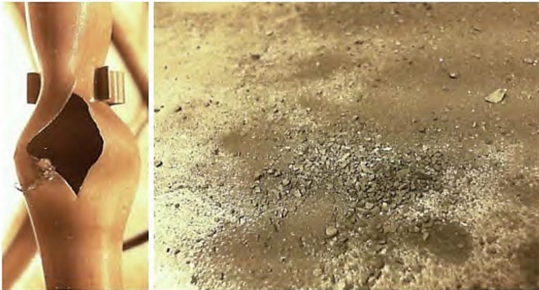
**Abb. 3.1** Beispiel einer Berst-Öffnung eines Brennstabs (74,5 GWd/t<sub>HM</sub>) nach einem KMV-Test im Halden-Reaktor (links), sowie ausgeworfener feinkörniger Brennstoff /STU 19a/
