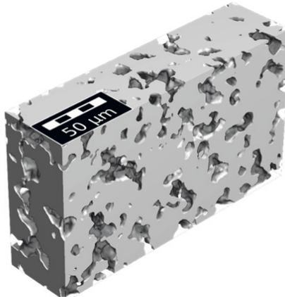
Abbildung 5.1: Mikrostruktur des mit 30 % Maisstärke hergestellten Trägers
