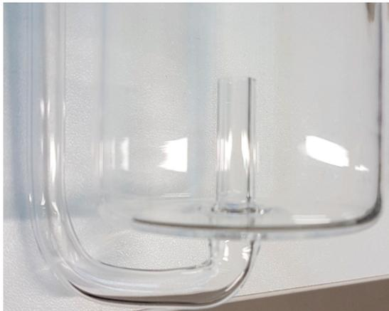
Abbildung 3.2: Version 2 des Feedeinlassrohrs der Testzelle für die Permeationsmessungen
