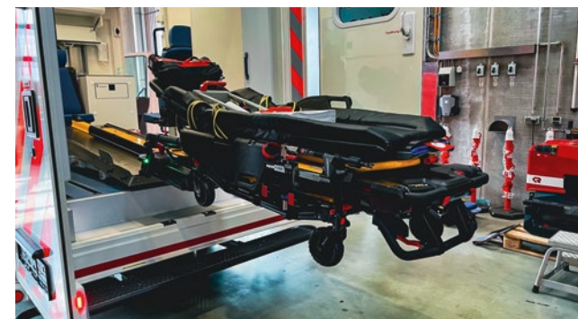
Die elektrohydraulische Fahrtrage „Power Pro2“ wird standardmäßig in allen neuen RTW verbaut.
