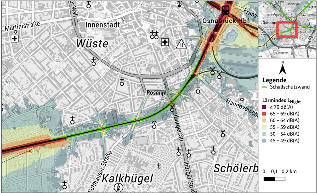
Abbildung 23: Schallausbreitung bei beidseitiger Schallschutzwand (in Hellgrün) in der Innenstadt Osnabrück und Vergleich im südlichen Verlauf. (Quelle: eigene Darstellung)
