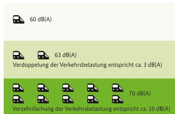
Abbildung 6: Pegeländerung durch Zunahme der Verkehrsbelastung (Quelle: eigene Abbildung)
