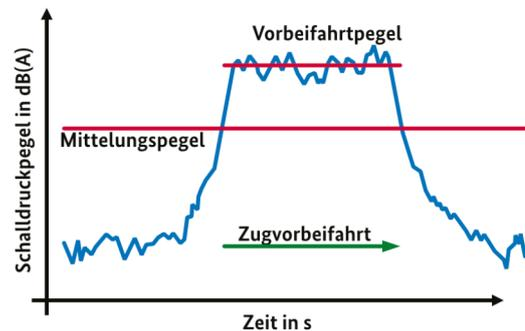
Abbildung 10: Zeitverlauf mit und ohne Eisenbahn (Quelle: Deutsche Bahn AG, Lärmschutz, 2016)
