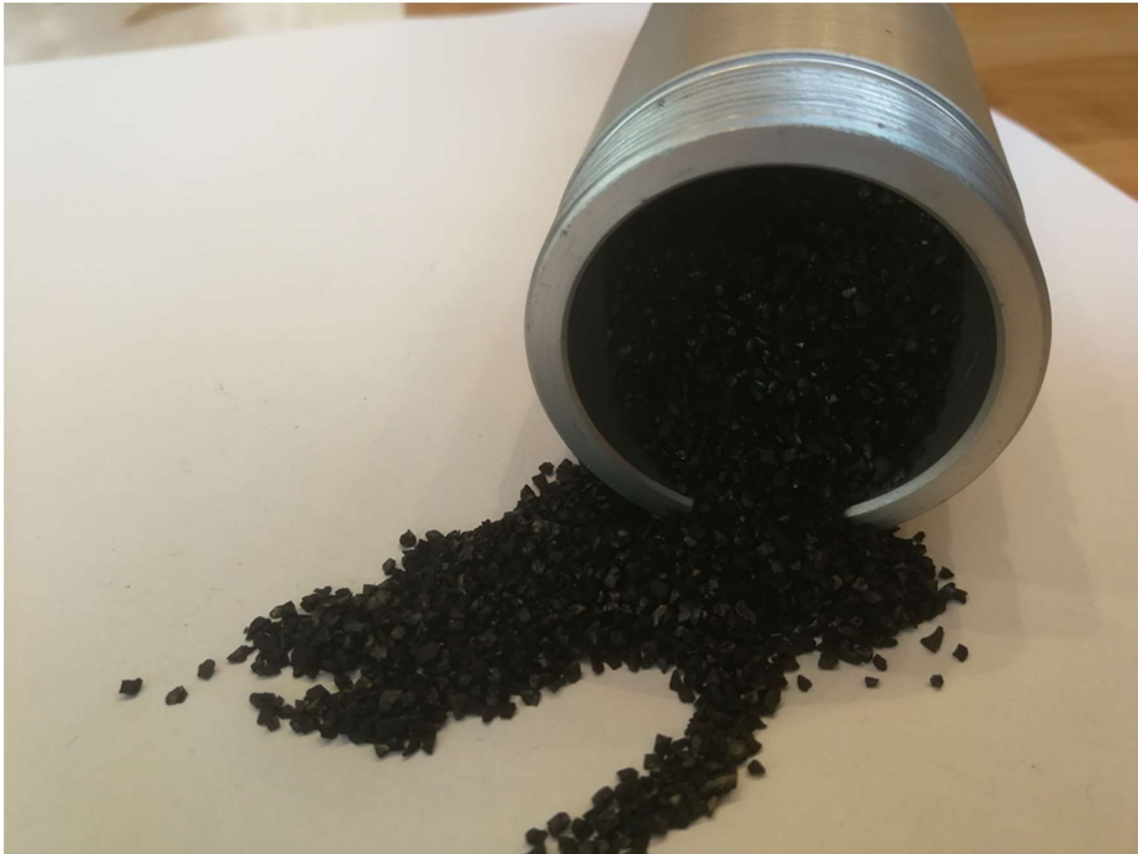
Foto 9: GSA-SG 12 PN-Hülse mit Dräger Aktivkohle Quelle: Gfl mbH
