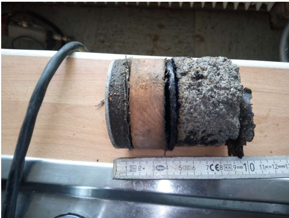
Bild 16: Bohrkern erste graue Schicht PVC-Boden dann 1,5 cm dicke schwarze Schicht, dann Holz, dann zweite schwarze Schicht, dann Estrich
