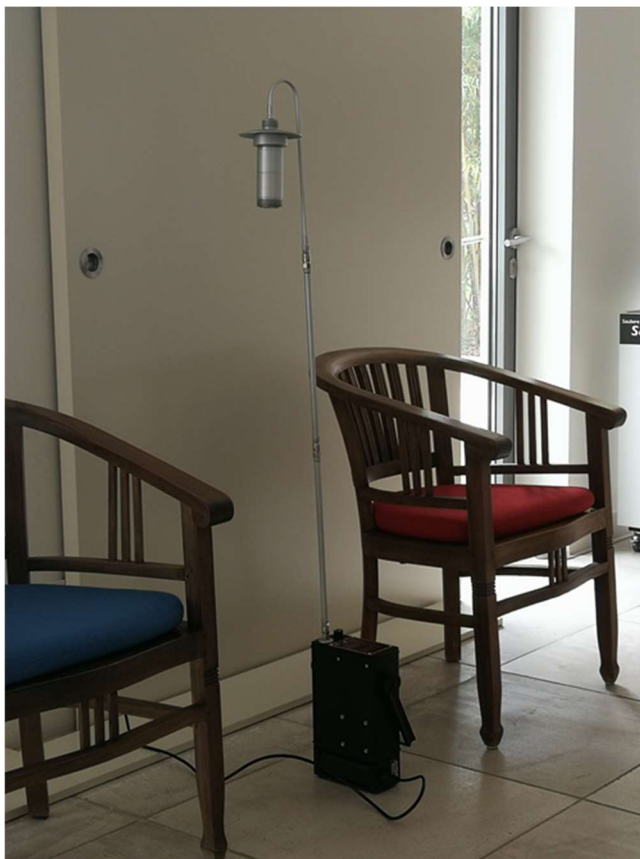
Foto 7: Probenahmegerät GSA- Pumpe SG 12 mit Hülse Quelle: Gfl mbH
