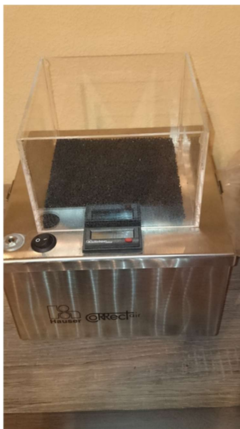
Foto 13: Probensammler Hauser Gerät 1 mit Ummantelung („Mausoleum“)
