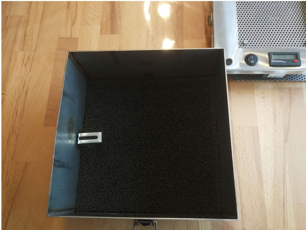
Foto 6: Probenahmegerät Hauser-Gerät 2 mit innenliegender Filtermatte Quelle: Gfl mbH
