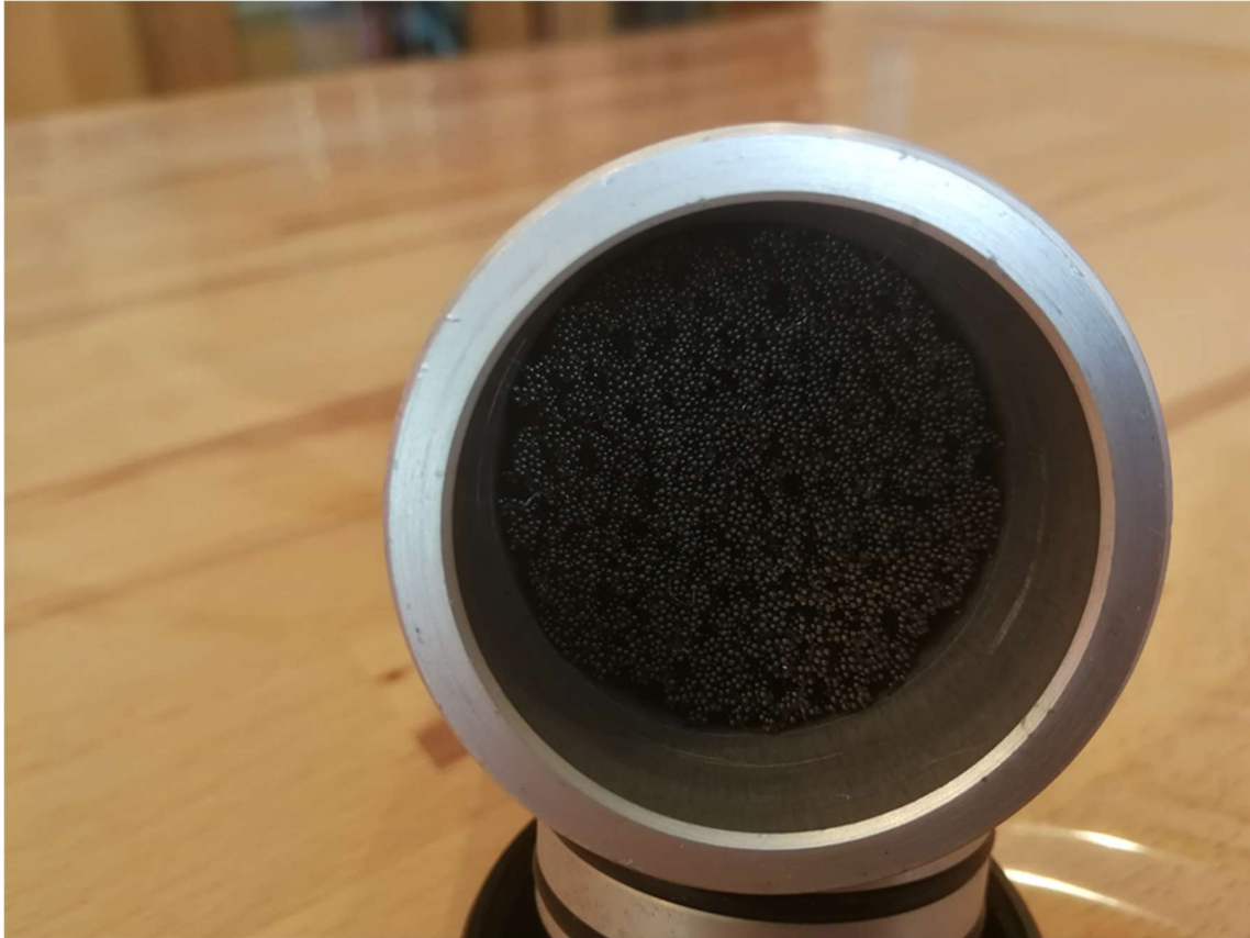
Foto 8: Filtermatte in der Hülse, Quelle: Gfl mbH
