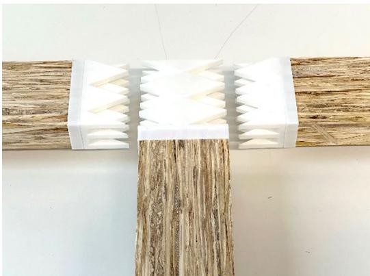
Anschluss Stütze Balken geschlossen
