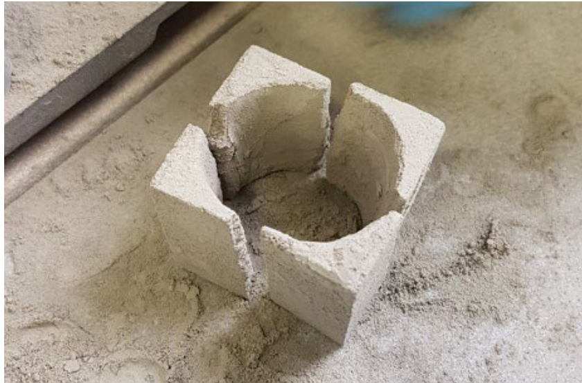
Abbildung 15: Fragile Struktur bei zu geringen Wandstärken
