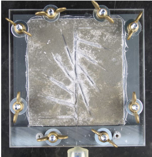
Abbildung 12: Mit Wasserglas nachbehandelter Probekörper zzgl. freigeblasener Bewehrungskanäle eingefasst in der vorgefertigten Injektionsapparatur und mit Silikon abgedichtet
