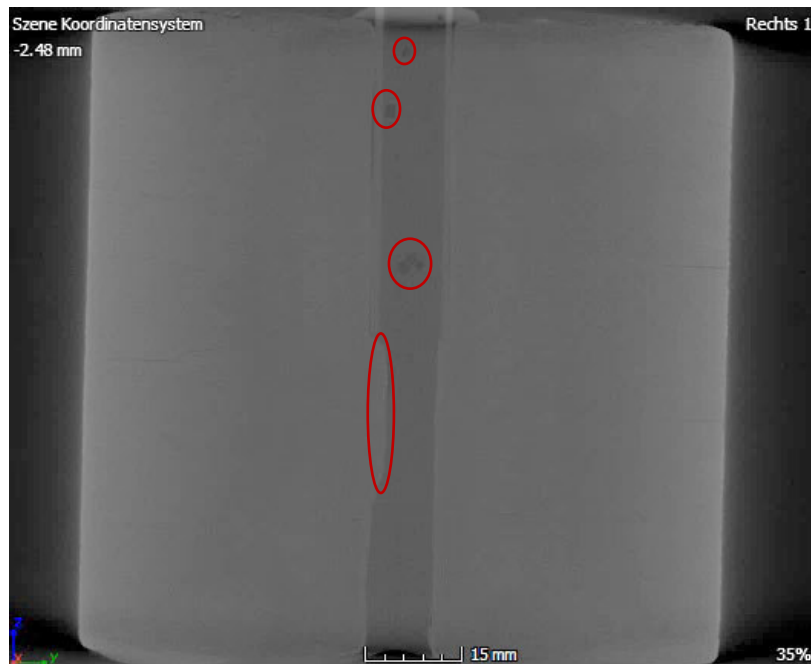
Abbildung 64: CT-Aufnahme eines Probekörpers mit gerader Bewehrungsführung
