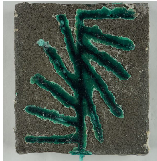
Abbildung 13: Mit Wasserglas nachbehandelter Probekörper zzgl. eines nachträglich injizierten Bewehrungsharzes
