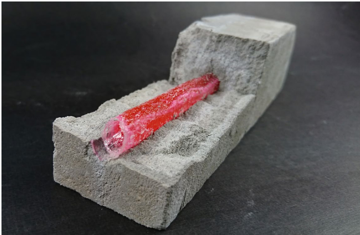
Abbildung 25: Probekörper ohne Trockencompound im Kanal zzgl. einer nachträglichen Injektion
