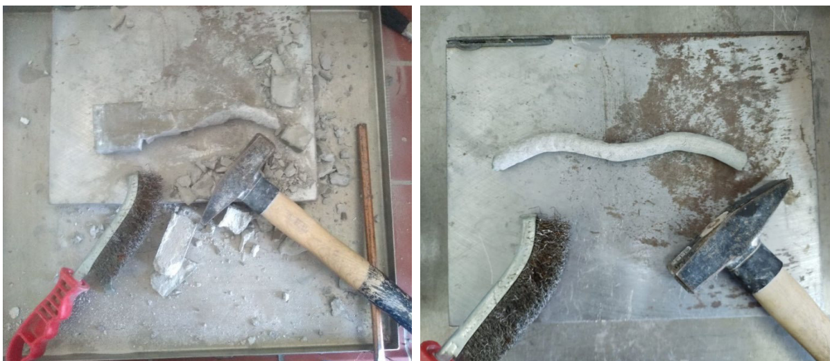
Abbildung 54: Auftrennung vom 3D-gedruckten Beton und Bewehrungsmaterial
