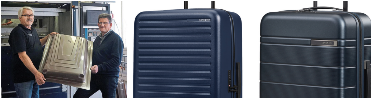
Abb. 6: (links) Herstellung einer Kofferschale aus Kunststoffolie. (mittig, rechts) Details zur Gestaltung und Aussteifung von Koffern.
