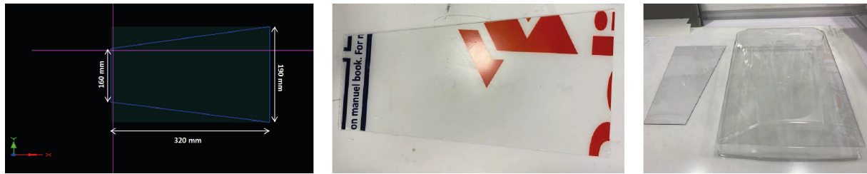
Abb. 116: Dimensionen und fertig ausgeschnittene, planare Folie (Links, Mitte). Planare und tiefgezogene Folie in der Gegenüberstellung (rechts)
