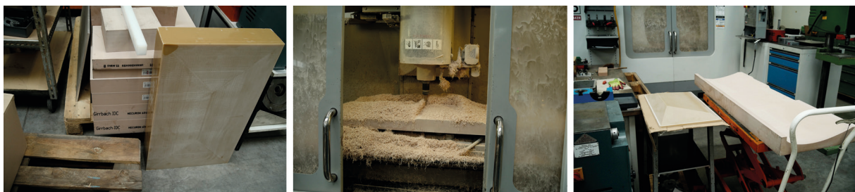
Abb. 49: Rohmaterial V4417 zum Formenbau; Rohmaterial in der Fräse beim Zerspannungsvorgang; Fertige Tiefzugform (links)
