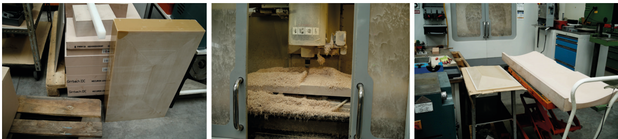
Abb. 96: v.l.n.r.: Grundform aus V 4417, Form im CNC-Bearbeitungszentrum, fertige Tiefzugwerkzeuge.
