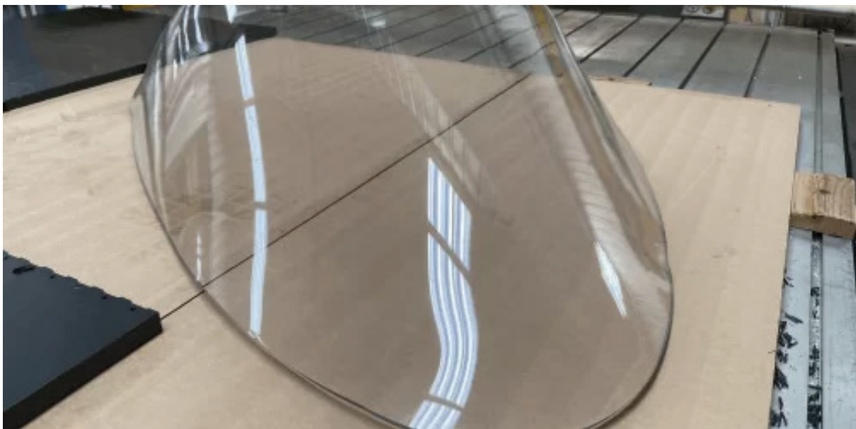
Abb. 25: Thermogeformte Halbschale aus Polycarbonat (Wohnwagenfenster)
