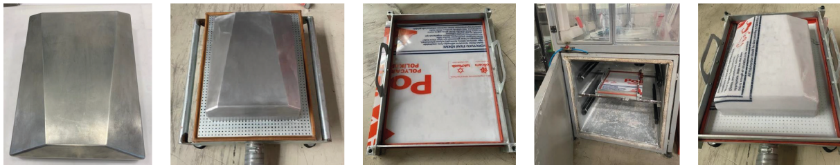
Abb. 115: Tiefzugwerkzeug, Tiefzugvorgang und tiefgezogene Folie auf dem Werkzeug.
