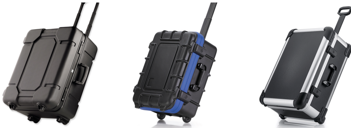
Abb. 7: Unterschiedliche Typen von Kofferschalen; (links) Schale mit Sicken zur Aussteifung, (mittig) Schale mit Aussteifungsrippen, (rechts) Schale aus Segmenten mit aussteifenden Alu-Schienen.
