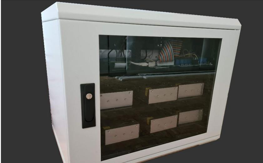
Abb. 63: Netzwerkschrank ausgestattet mit der Steuereinheit und den 5 Volt Netzteilen
