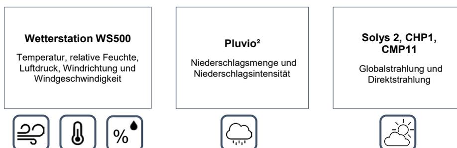
Abb. 68: Globale Messtechnik zur Ermittlung der Außenbedingungen (Makroebene)
