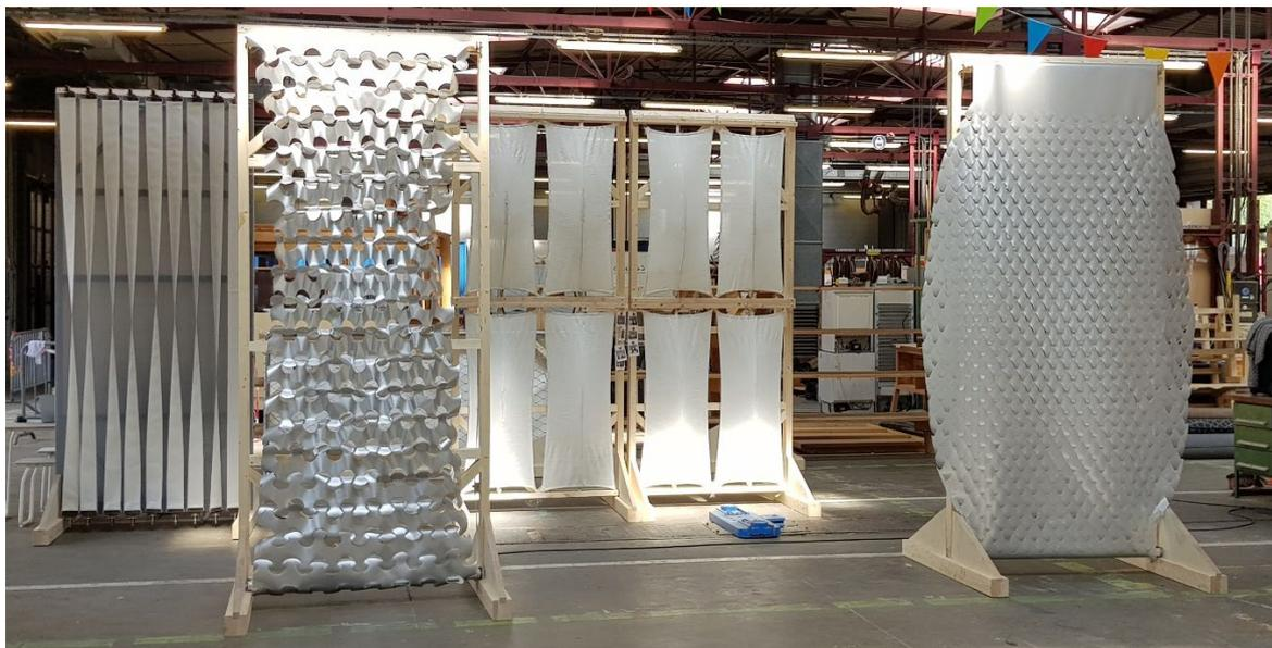
Abb.24: Realisierung einiger Konzepte im 1:1 Maßstab mit einer Modulhöhe von ca. 3 m sowie einer Breite von ca. 1 m, Foto: ILEK / C. Eisenbarth
