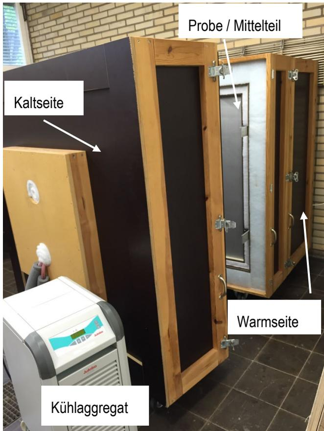
Abb. 50: Hotbox mit Kühlaggregat
