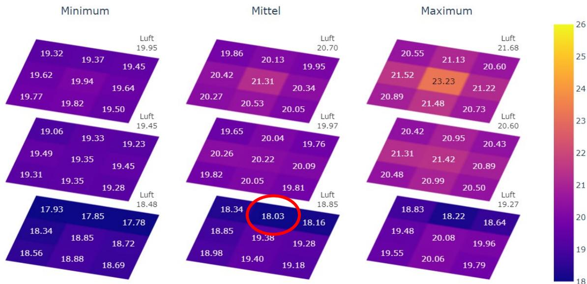
Abbildung 121: IR-Decke Zentral mit Tischen, räumliche Darstellung der gemessenen Globetemperaturen
