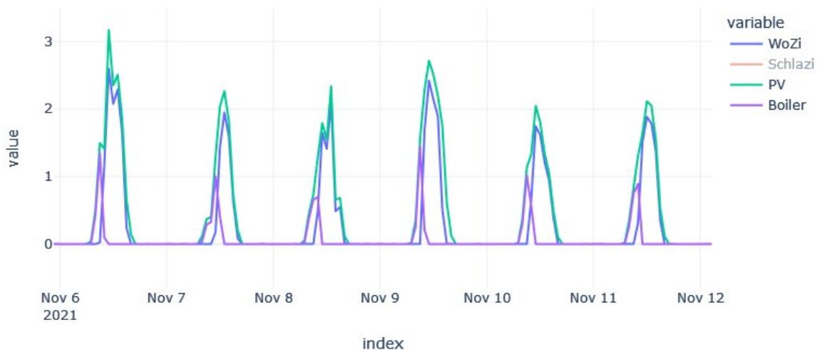
Abbildung 51: Beispielhaftes Wochenprofil im November von PV-Ertrag und Stromverbrauch für die elektrische Fußbodenheizung im Hauptraum (Wohnzimmer) und dem Trinkwasserboiler im Mikrohaus (Heizperiode 2021/2022)
