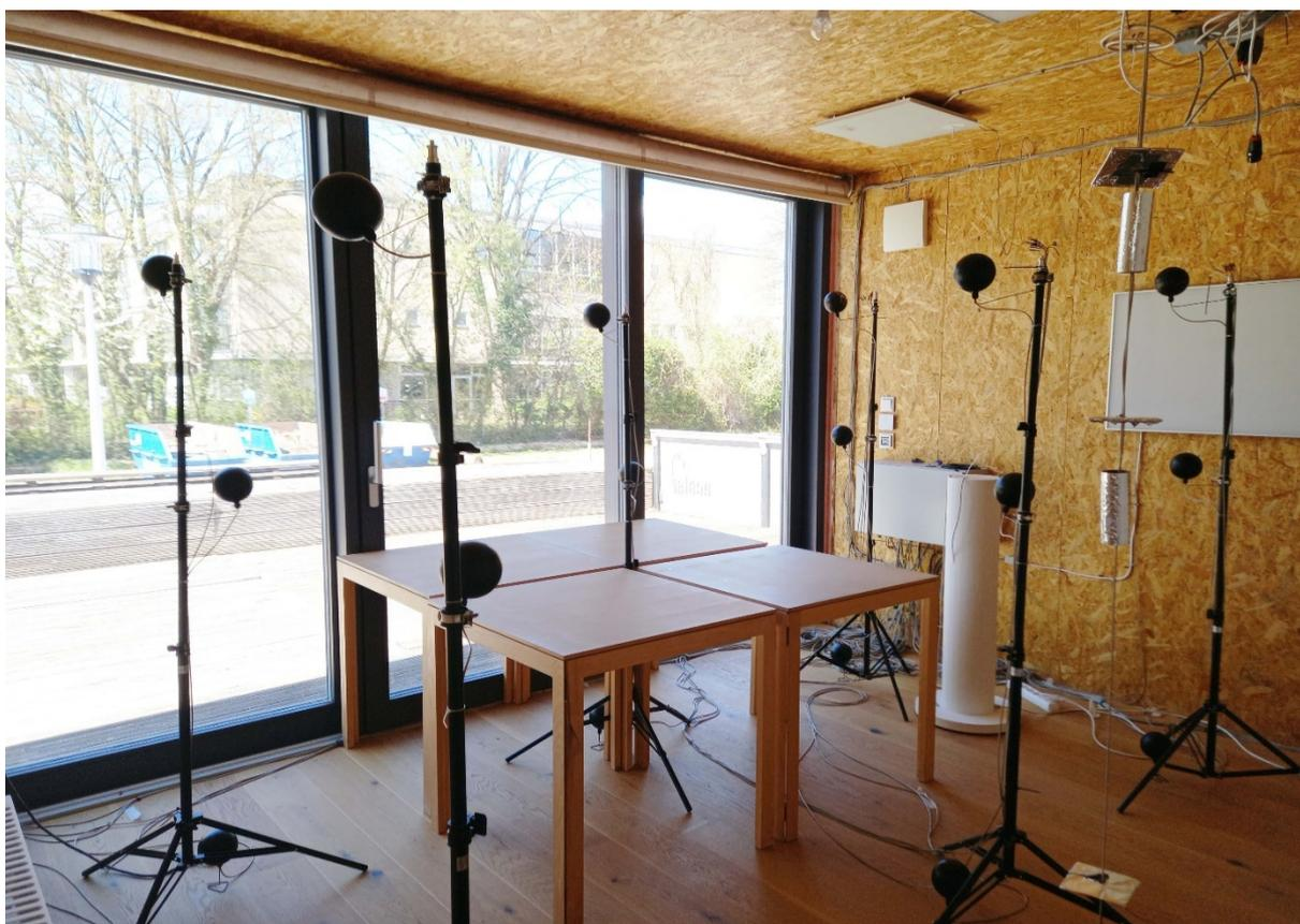
Abbildung 120: Position der Tische für die Vergleichsmessung "Strahlungsschatten"
