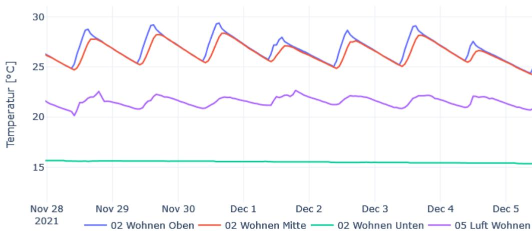
Abbildung 54: Beispielhaftes Wochenprofil im Januar der Temperaturen in der Fußbodenheizung (Oberflächentemperatur / Kerntemperatur / Temperatur unter der Dämmebene) sowie die Lufttemperatur im Mikrohaus (Heizperiode 2021/2022)
