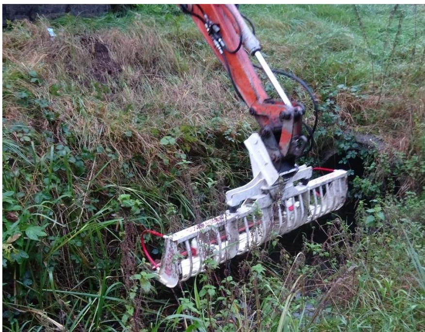
Abb. 4: Der Mähkorb ist ein häufig verwendetes Gerät bei der Gewässerunterhaltung. Dieser schneidet mit einem Messerbalken die Vegetation. (Bild: I. Idilbi)
