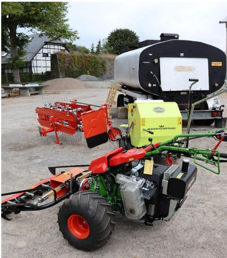
Abb. 2: Trio der insektenschonenden Mahdgeräte: Geräteträger (Agria 5900 Cyclone 22) mit höhenverstellbarem Doppelmesser-Portalmähwerk, Heuwender und kleiner Ballenpresse (Bild: H. Rubenbauer, WWF)
