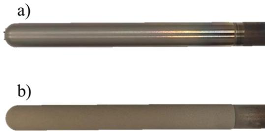
**Abbildung 33:** Einfluss der Überhitzung von Zylinderproben beim PS-PVD Prozess
