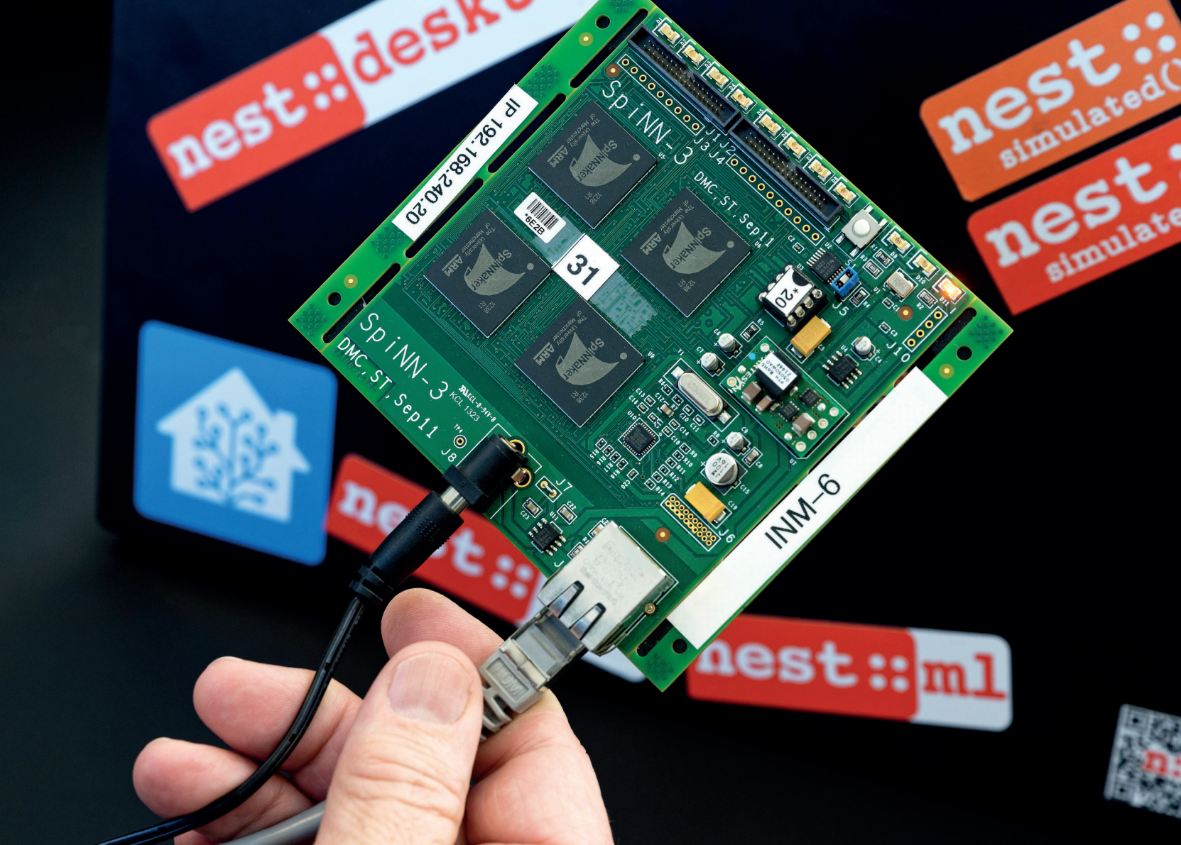
Bild 1: Neuronen- und Synapsenmodelle, die in der Standardsprache NESTML ausgedrückt sind, können mithilfe eines Code-Generierungsansatzes auf verschiedenen Rechnerarchitekturen simuliert werden: zum Beispiel auf CPUs oder GPUs über den Simulator NEST oder sogar auf der neuromorphen Hardware SpiNNaker. Foto: Peter Winandy
