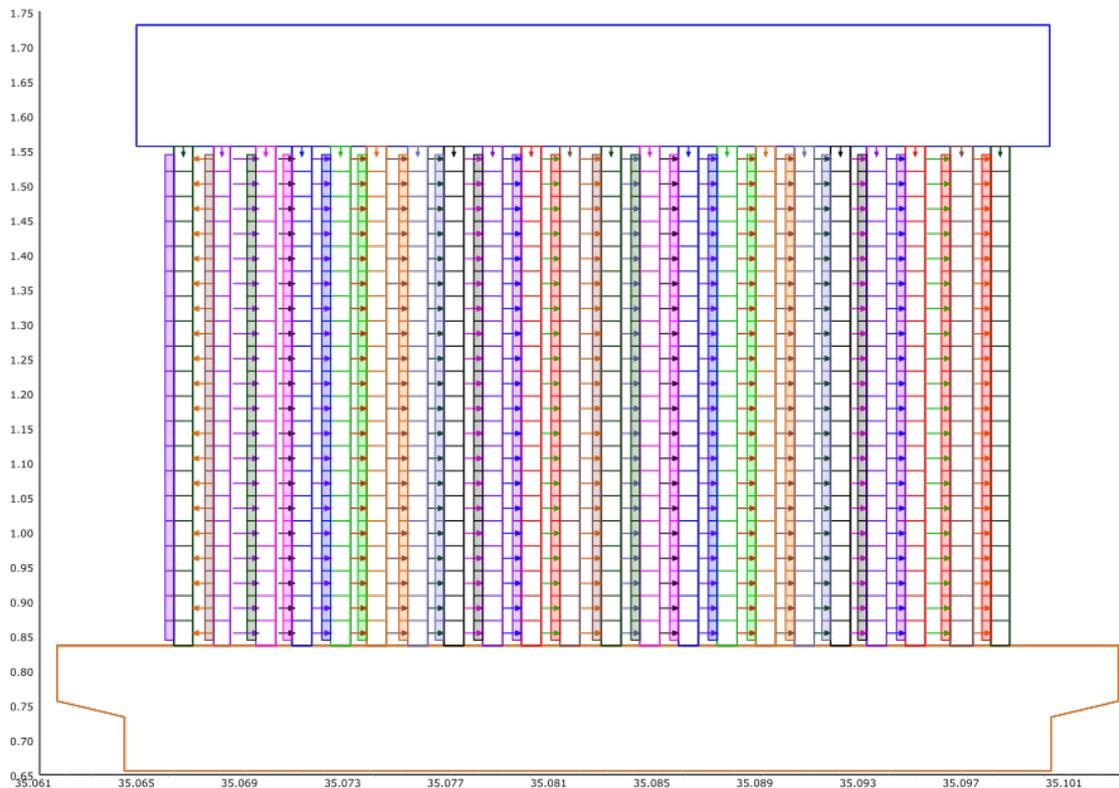
**Abb. 5.27** Erweitertes Kernmodell: Kühlkanal in 22 Unterkanälen geteilt, 20 Knoten in vertikaler Richtung
