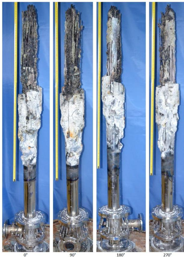
**Abb. 5.25** Erscheinungsbild des Bündels nach dem Test aus 4 Winkelpositionen (ohne den obersten Abschnitt) /STU 18a/
