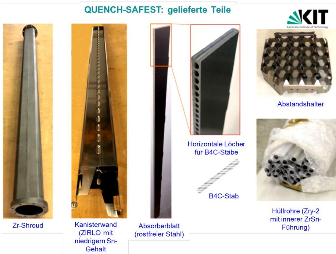
**Abb. 5.46** Bestandteile des Testbündels für QUENCH-20 /HOL 18b/
