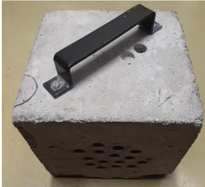
**Abb. 3.6** Verwendeter Testblock aus Barytbeton
