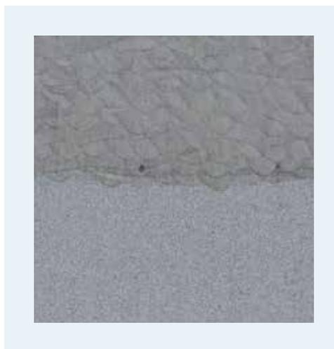
1 Übergang zwischen LPBF-Bereich (oben) und gegossenem Grundbauteil.
