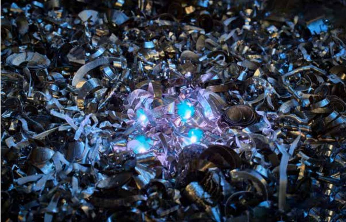
1 LIBS-Messungen von Stahlspänen.
