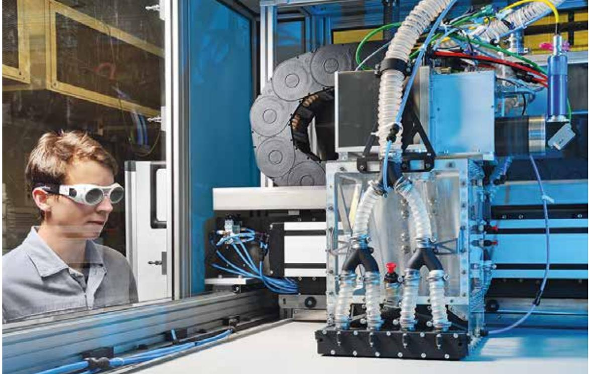
*Maschinentechnologie für das Laser Powder Bed Fusion.*
