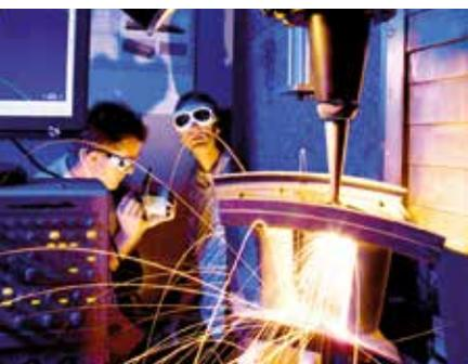
*Bohren mit Laserstrahlung.*
