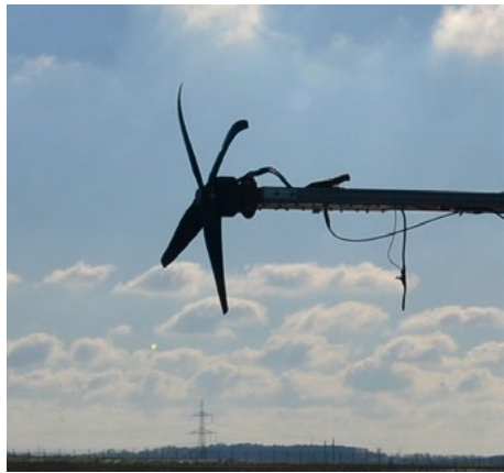
Bilder des Versuchsaufbaus im Freifeld zur Untersuchung der Schallemission (links); einer Windkanalmessung ohne Umman- telung (mittig) und mit Mantel (rechts) / Images of the test setup in the open field for investigating sound emission (left); a wind tunnel measurement without shroud (centre) and with shroud (right)
