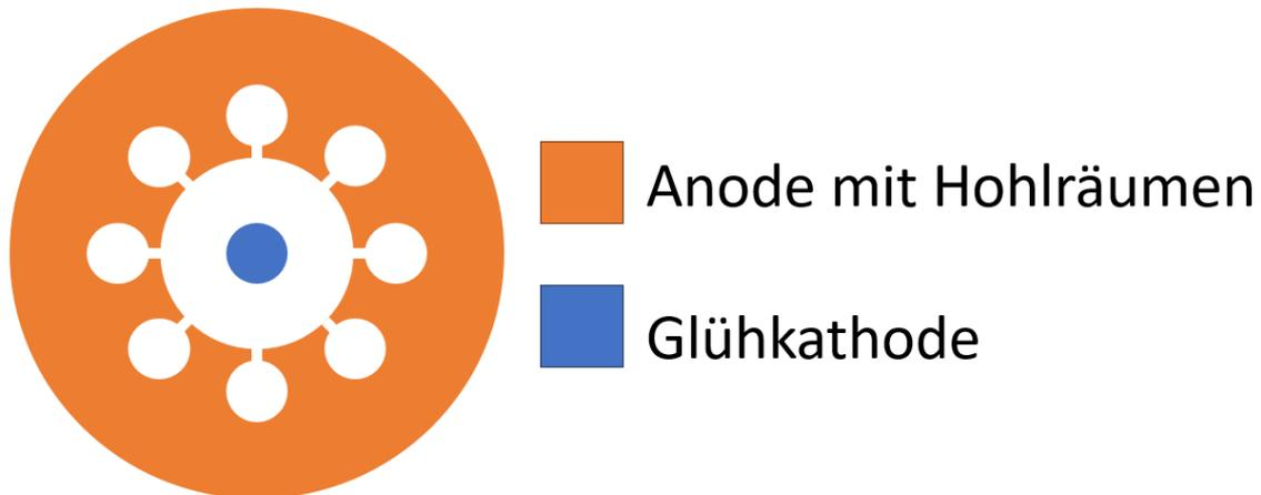
**Abb. 1.7** Prinzipieller Aufbau eines Magnetrons
