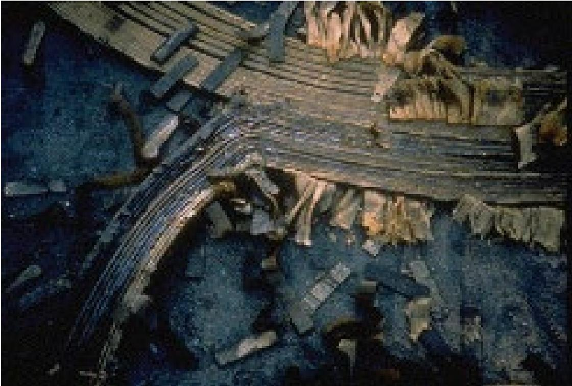
**Abb. 2.8** Transformatorschaden während des Sonnensturms /USE 08/
