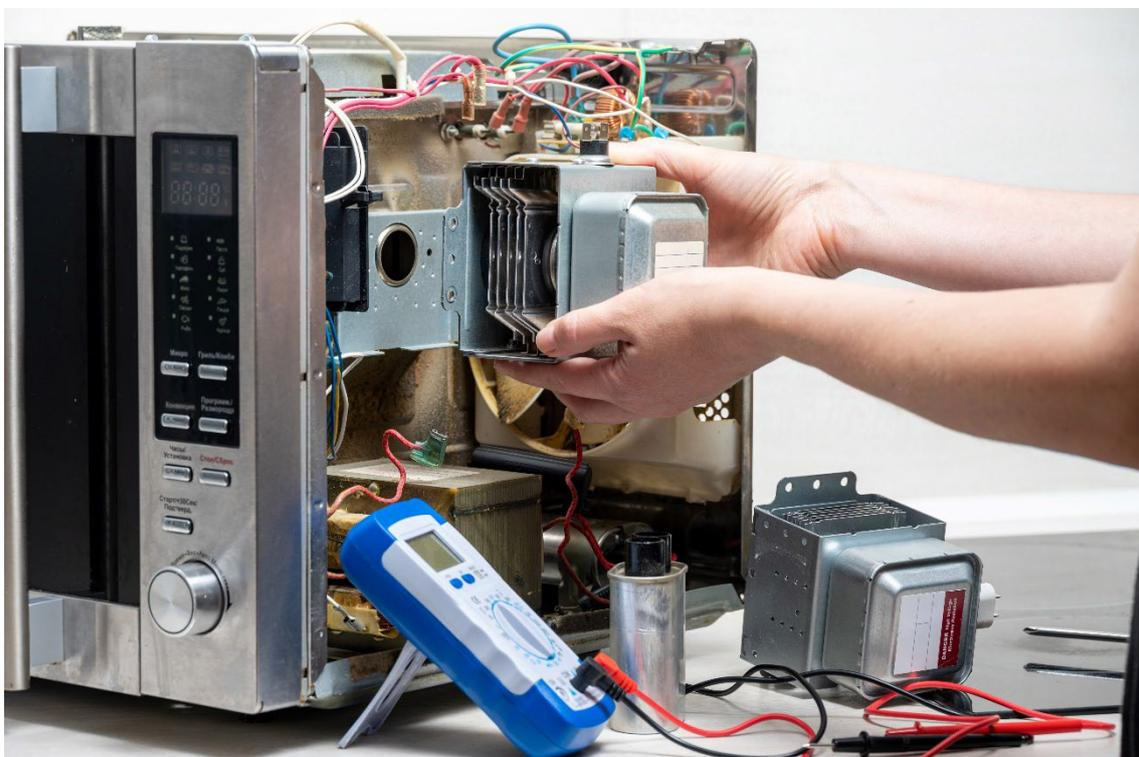
**Abb. 1.6** Ausbau eines Magnetrons aus einer Mikrowelle, Quelle: Kalabi Yau/Shutterstock.com
