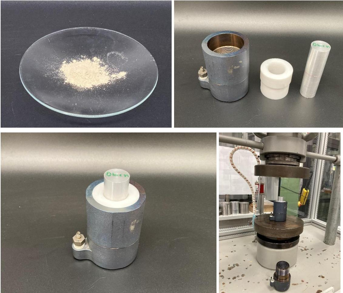
**Abb. 2.1** Probenpräparation des Bayrischen Bentonits B25
