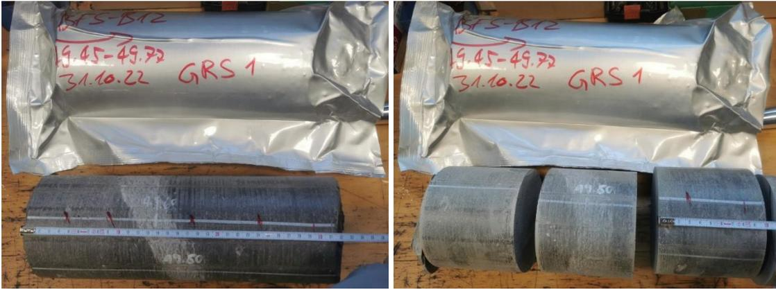
**Abb. 2.5** Der für die Probenpräparation verwendete Opalinuston-Bohrkern
