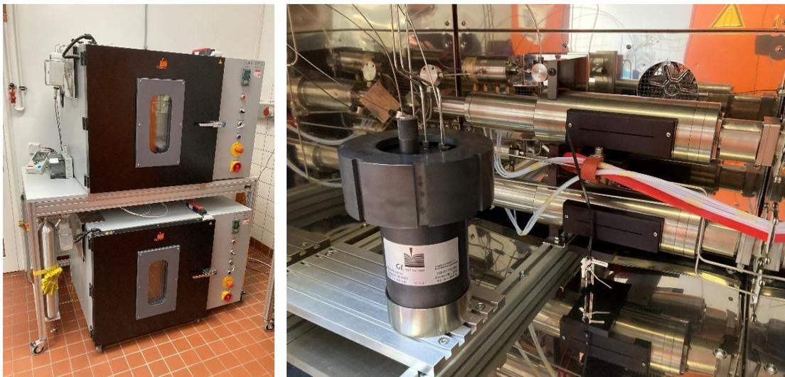
**Abb. 2.10** Zwei Temperaturprüfschränke für temperierte Quelldruck- und Permeabilitätsmessungen (links) mit jeweils einem eingebauten Quizix Doppelpumpensystem und einem Druckbehälter zur Aufnahme der Oedometerzelle (rechts)
