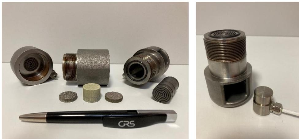
**Abb. 2.8** Komponenten der Oedometerzelle im Größenvergleich (links) und obere Komponente der Oedometerzelle mit Stempel und Druckkraftsensor (rechts)
