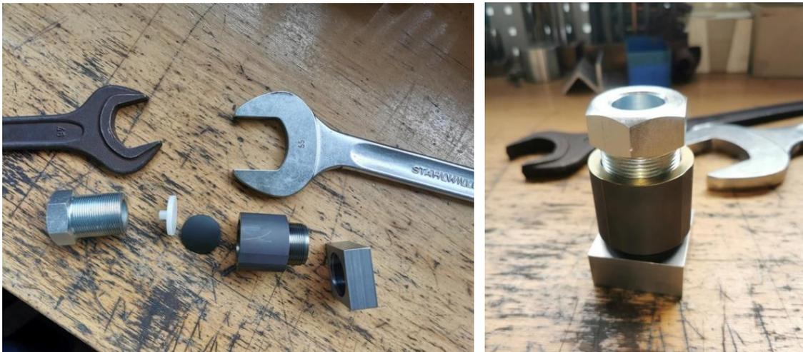
**Abb. 2.17** Transportbehälter für den Probenversand an die TU Darmstadt in Komponenten zerlegt (links) und verschraubt (rechts)
