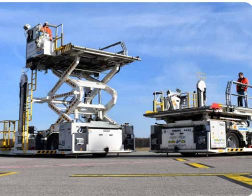
Auf dem Vorfeld sind elektrische Lifter für die Abfertigung im Einsatz.
