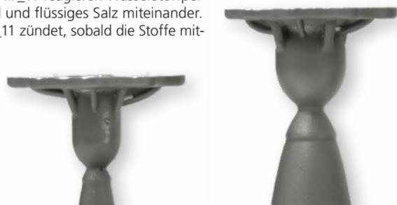
Das HyNOx-Triebwerk beim Test im DLR-Institut für Raumfahrtantriebe in Lampoldshausen. HyNOx besteht aus Lachgas und Ethan. Die passenden Triebwerke für den Treibstoff werden im 3D-Druckverfahren hergestellt.
