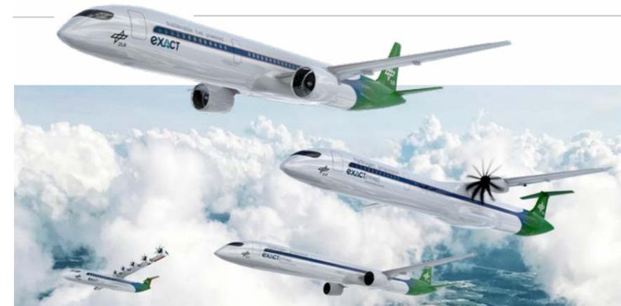
Diese Illustration zeigt Konfigurationen mit verteilten Antrieben (links unten) sowie Turbo-prop- und Turbofan-Antrieben.
