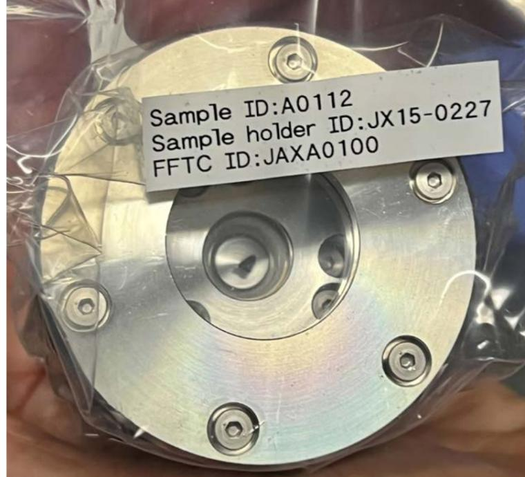
Die Staubkörnchen vom Asteroiden Ryugu sind in Edelstahlbehältern vor atmosphärischen Einflüssen durch eine Plexiglasscheibe geschützt. Diese ermöglichte aber erste Untersuchungen und Messungen.
