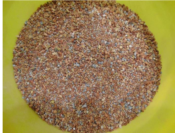
Abbildung 96: Gesamtprobe Ziegelrecyclingmaterial 4 nach dem Brechen und Sieben (0,5 – 4 mm)
