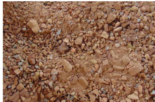
Abbildung 2: Gemischter Mauerwerksbruch nach dem Brechen
