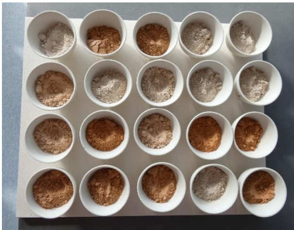
Abbildung 85: Beispiel der verschiedenen Proben zur Bestimmung der Glühverluste zur Berechnung des Ziegel- bzw. Betonanteils im magnetischen Outputs
