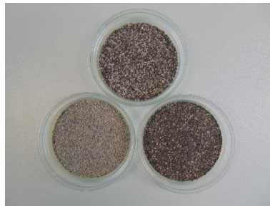
Abbildung 83: Mischung (50/50 oben) Fraktion 0,5 mm – 1,0 mm sortiert in nicht-magn. (links) und magn. (rechts) Anteil
