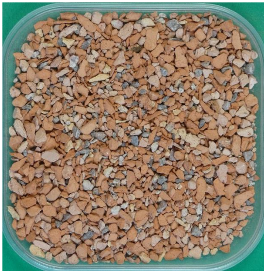
Abbildung 91: Magnetischer Anteil einer Mischung nach der Sortierung
