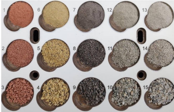
Abbildung 90: Reinstoffe in unterschiedlichen Fraktionen v.l.n.r.: roter Ziegel, gelber Ziegel, schwarzer Ziegel, Beton mit Quarz-Körnung, Beton mit Kalksteinkörnung
