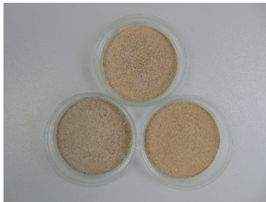
Abbildung 82: Mischung (50/50, oben) Fraktion 0,063 mm – 0,5 mm sortiert in nicht-magn. (links) und magn. (rechts) Anteil
