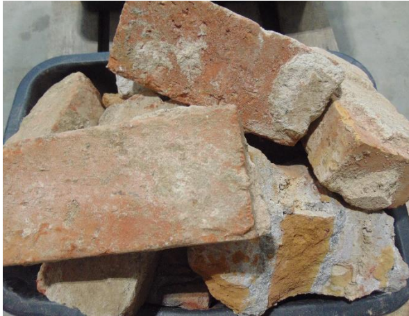
Abbildung 95: Ungebrochenes Ziegelrecyclingmaterial 4 direkt vom Recyclinghof
