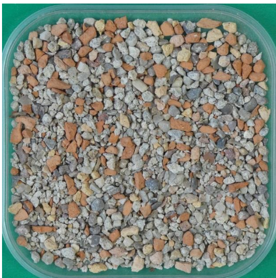
Abbildung 93: Nicht-magnetischer Anteil der selben Mischung nach der Sortierung
