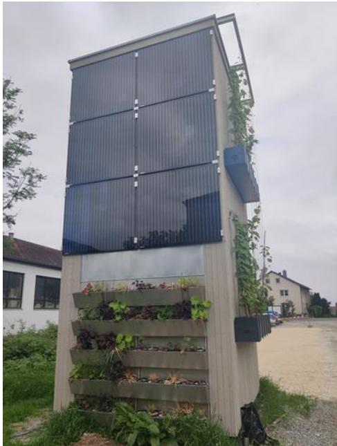
Die quaderförmige Konstruktion ermöglicht es, verschiedene greenTES-Konstruktionsvarianten an allen vier Fassadenseiten zu testen. Die Gesamtkonstruktion ist dabei so gestaltet, dass durch die Quaderform mit Bodenplatte und Dach ein Innenraumklima geschaffen wird. Dies erlaubt hygrothermische Messungen.
