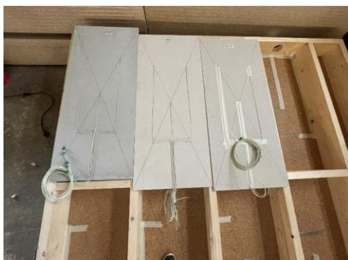
c) Führung der Thermoelemente je Gefach
