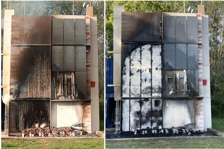
Abbildung 146: Schäden an der PV-Fassade nach dem Brandversuch
