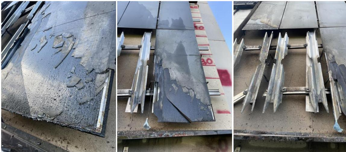
Abbildung 147: Bereich um den Prüfkörper nach dem Brandversuch
