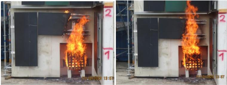
Abbildung 133: Schäden an der Fassade nach Brandversuch, Horizontales Modul (links und Mitte), Modul rechts der Brandkammer (rechts)
