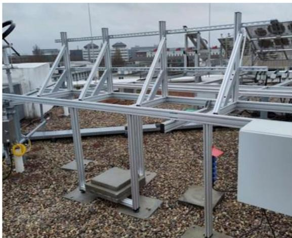
Abbildung 90 Fotografie des Versuchsaufbaus im Reallabor des HZB mit drei SolarChip-Fassadelementen Prototyp MA1KV2.
