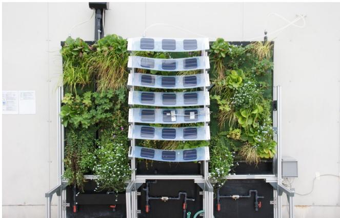
Abbildung 60: Vertikale Module in der Versuchsphase im technischen Maßstab mit Solarpanel (Quelle: Aicher/b.is, 2021).
