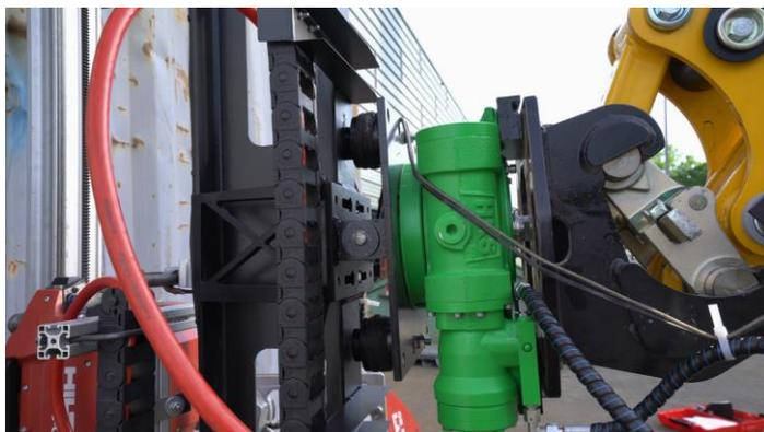
Für die ersten Schnittversuche wurde die Sägevorrichtung mithilfe des BROKKS auf einer Betonplatte positioniert. Im ersten Schritt war es wichtig, dass Faktoren, wie ein Absinken der Hydraulik, die bei einem vertikalen Schnitt zu erwarten sind, noch nicht auftauchen können.
