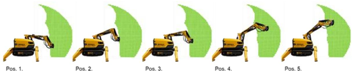
Um die in der Simulation berechneten Kraftwerte zu überprüfen, wurde eine Kraftmessdose am Endeffektor der Baumaschine (BROKK 170) montiert (siehe Abb. 6). Die horizontale Kraft auf den Endeffektor der Baumaschine wurde über das Messgerät (HBM U2B 100 kN) gemessen. Die Positionen wurden gewählt, um die Kraftfähigkeit des BROKK 170 zu testen:
