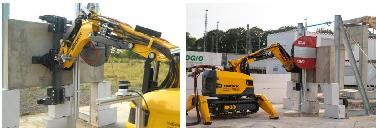
Ein weiteres charakteristisches Merkmal dieses Endeffektors ist die Halteplatte, die über ein Kippgelenk mit dem Hauptgestell verbunden ist. Gemäß Konzeptzeichnung und weiterer technischer Ausführungen bietet diese Konfiguration mehrere Vorteile:
