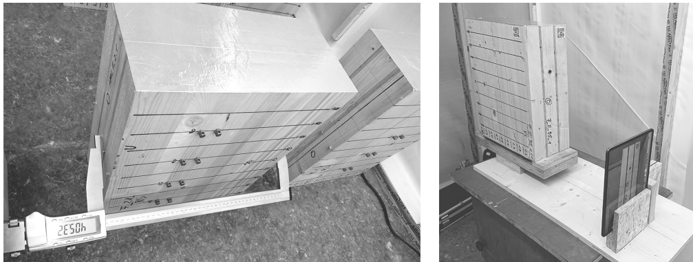
(a) Messprinzip der Verformungsänderung an eingedrehten Messschrauben
