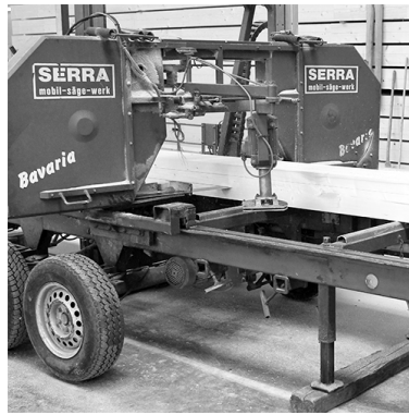
(b) Auftrennen der BSH Balken
