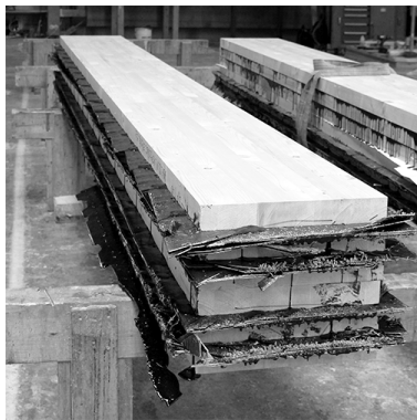
(g) Verklebte HBH Prüfkörper
