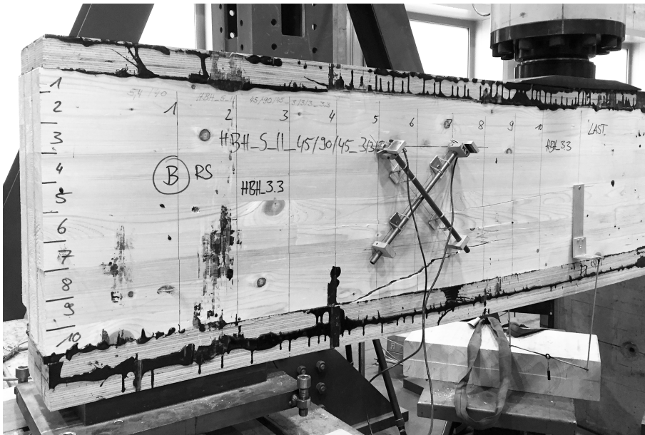
Abbildung 5.14 Realisierter 3PB-Versuchsaufbau zur Bestimmung der Schubtragfähigkeit von HBH
