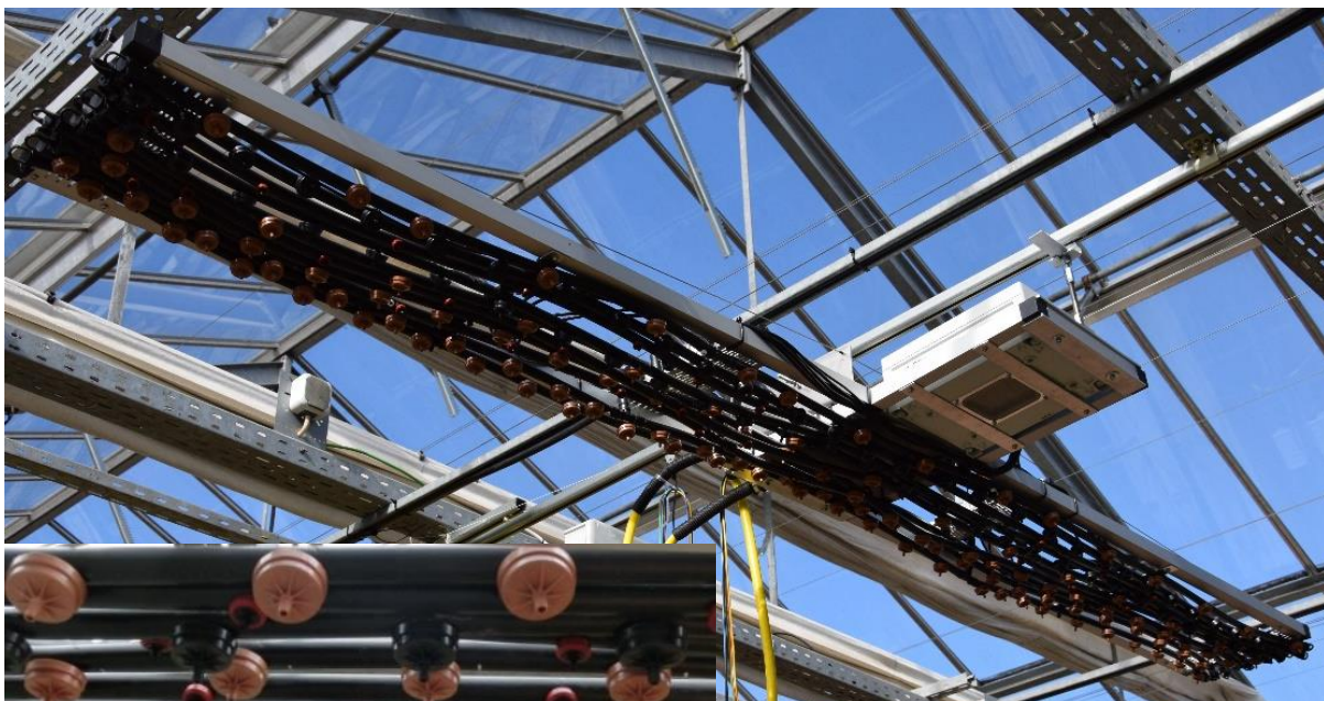
Abb. 11: Regensimulator mit einem Detailausschnitt der unterschiedlichen Tropfern (rot = Tropfleistung 2 l/h, braun = 4 l/h, schwarz = 12 l/h) auf den insgesamt zehn Tropfbewässerungsschläuchen (Quelle: HSWT)
