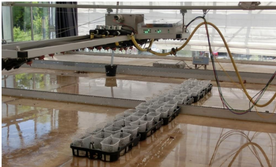
Abb. 12: Ermittlung der mit dem Niederschlagssimulator möglichen Regenmengen und deren räumliche Verteilung (Quelle: HSWT)
