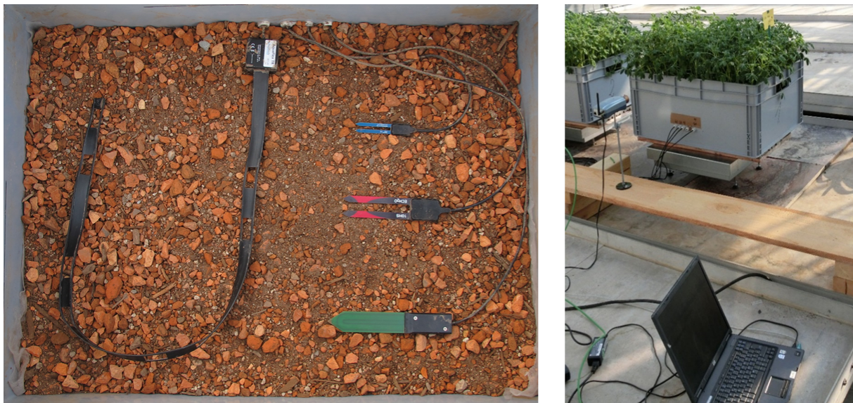
Abb. 1: In das Versuchsgefäß eingebaute Sensoren (links) und gesamter Versuchsaufbau (rechts) bestehend aus dem auf einer Waage stehenden und mit Lupinen bepflanzt Versuchsgefäß, der Kamera zur Dokumentation der Turgeszenz und im Vordergrund dem PC zur Erfassung der Messdaten (Quelle: HSWT)
