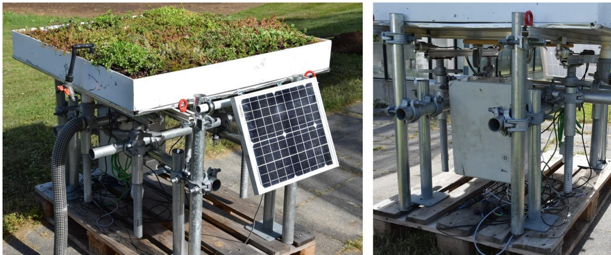
Abb. 23: Prototyp der solar betriebenen Sensorplattform mit einfacher Sedumvegetation (links) und Detailansicht der modularen Unterkonstruktion (rechts) mit den Wägezellen sowie der Elektronik und dem Batteriespeicher (Quelle: HSWT)
