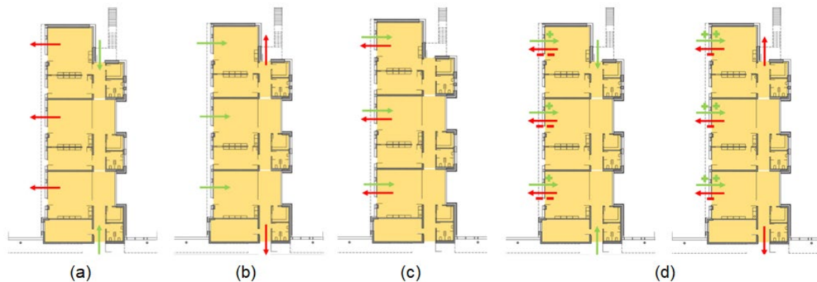
Abbildung 14 Luftstrommanagement zwischen benachbarten Räumen
