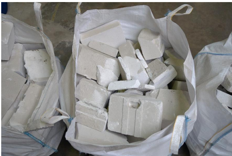
Abbildung 5: Nahaufnahme eines Big Bags mit Porenbetonabbruch
