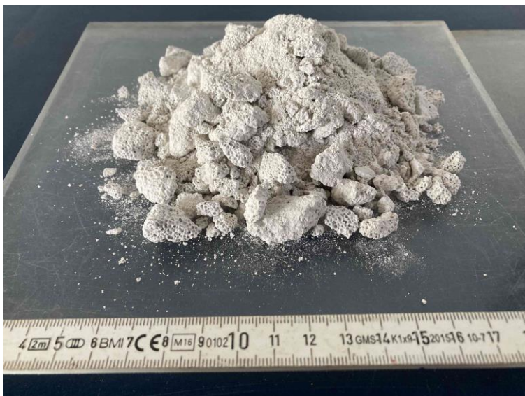
Abbildung 14: Grobes Porenbetongranulat aus Abbruchmaterial (PBG-A grob ) nach dem ersten Brechvorgang
