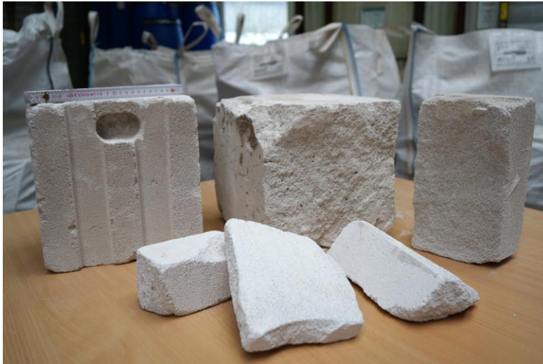
Abbildung 6: Exemplarische Porenbeton-Bruchstücke aus Abbruchmaterial
