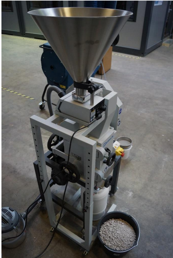
Abbildung 15: Zweiter Schritt der Aufbereitung im Backenbrecher
