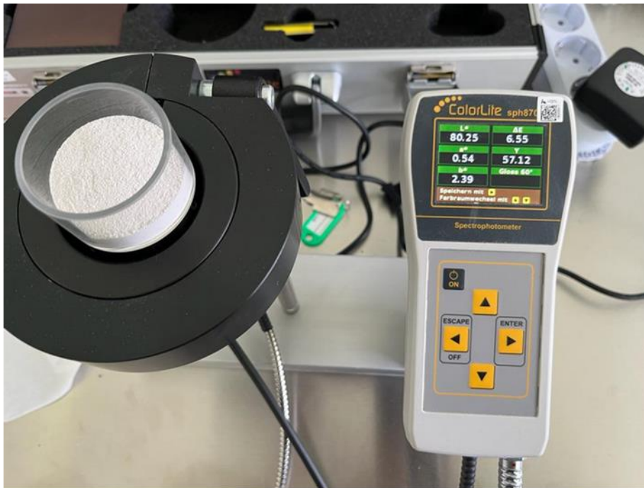
Abbildung 19: Bestimmung des Weißgrades mit dem Spektralphotometer
