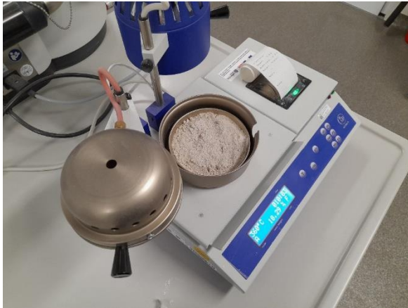
Abbildung 9: Bestimmung des Kristallwassergehaltes vom RC-Gips
