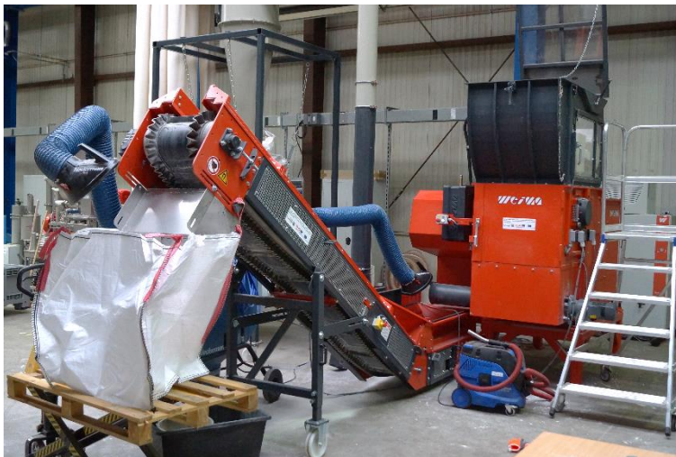
Abbildung 13: Vorzerkleinerung des grobstückigen Porenbetonabbruchs im Einwellenzerkleinerer
