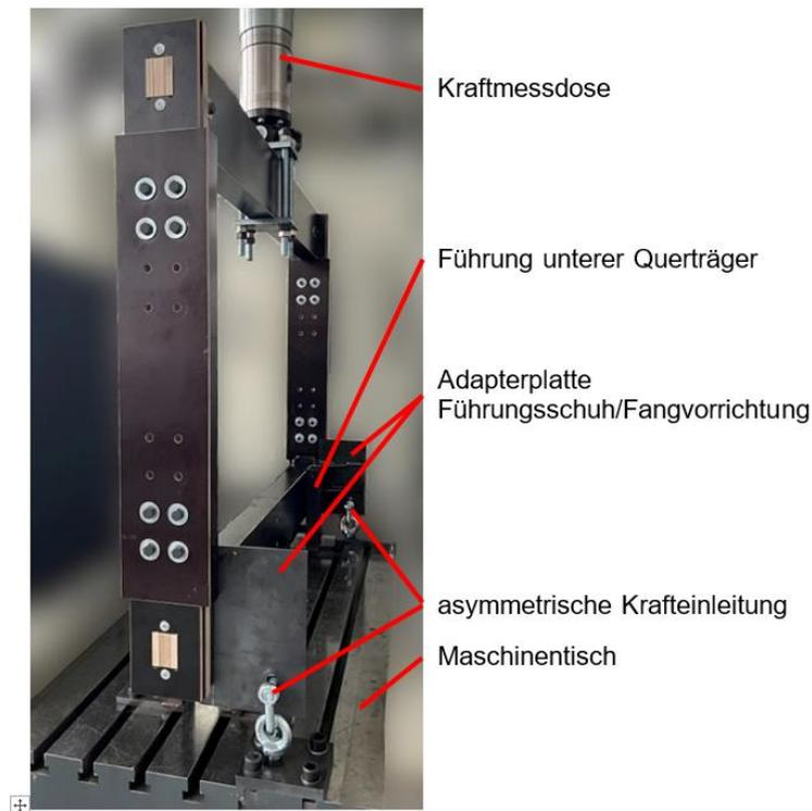
Abbildung 23: Fangrahmen mit azentrischer Lagerung zur Simulation der Fangvorrichtung
