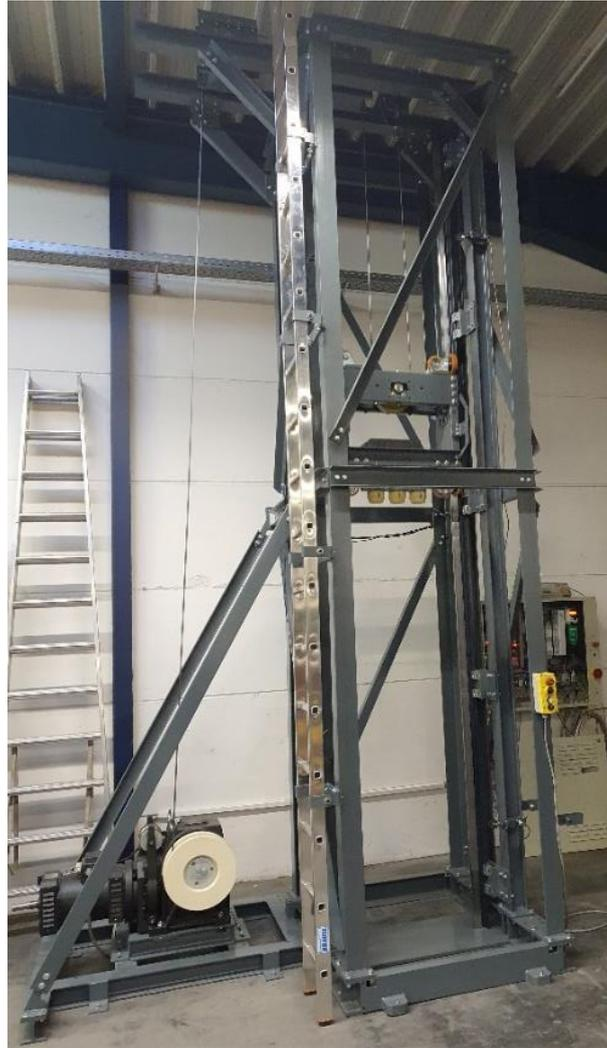
Abbildung 25: Prüfstand für die Mehrlagenwicklung und den getriebelosen Antrieb
