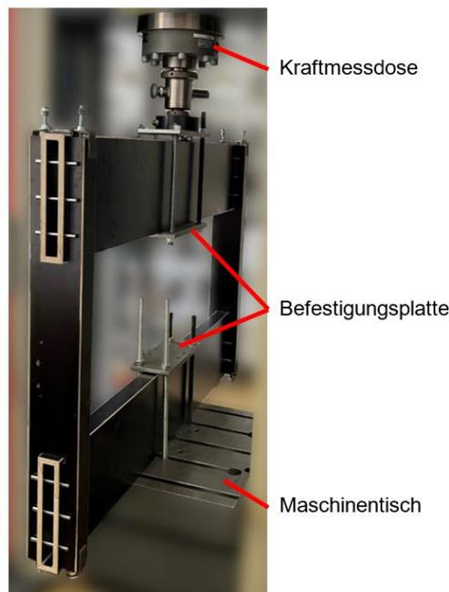
Abbildung 13: statischer Zugversuch mit Fangrahmenprototyp, Fall A
